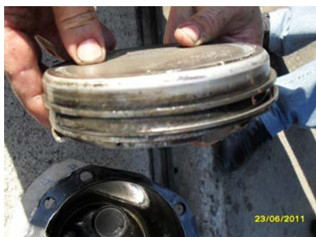
Слика 4.16 – Изглед оштећења клипа
