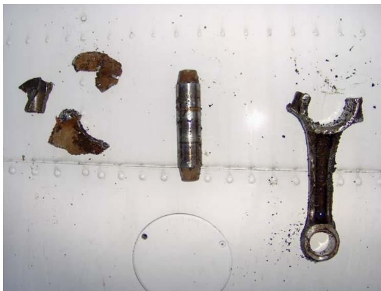
Слика 4.5 – Пронађени делови мотора CONTINENTAL IO-520-F , сер. бр. 291054 на месту удеса
