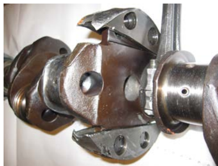
Слика 4.14 – Изглед оштећене клипњаче Слика 4.15 – Место испадања осовинице
