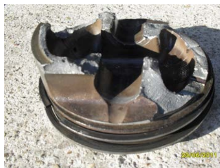
Слика 4.17 – Место пуцања клипа
