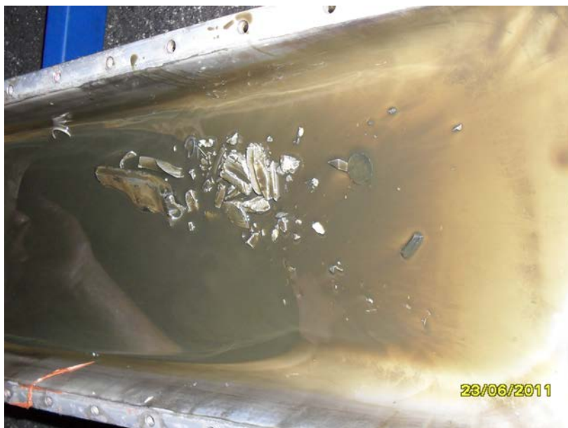
Слика 4.9 - Делова мотора који су пронађени у таложнику мотора CONTINENTAL IO-520-F, сер. бр. 291054
