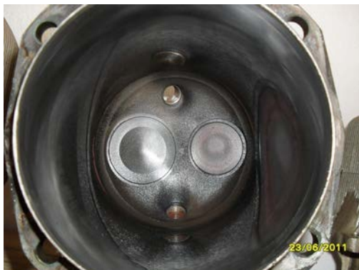
Слика 4.8 – Изглед стања цилиндра са вентилима и клипа са осовиницом
