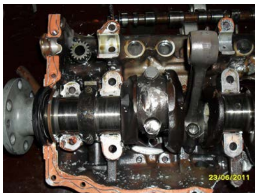
Слика 4.7 – Изглед првилно монтираних елемената мотора, елементи клипа и коленастог вратила са лежајевима
