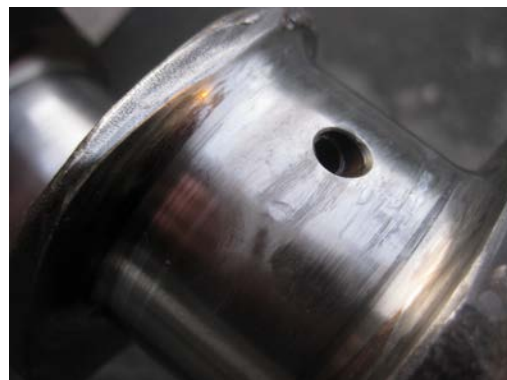
Слика 4.11 – Оштећења на 4. колону коленастог вратила
