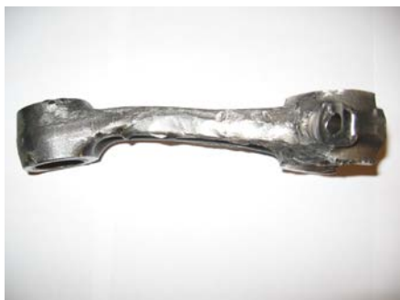
Слика 4.14 – Изглед оштећене клипњаче Слика 4.15 – Место испадања осовинице
