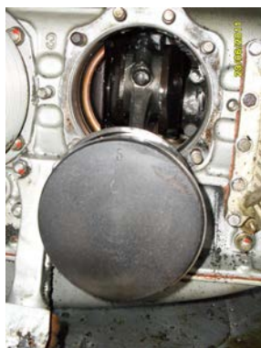
Слика 4.7 – Изглед првилно монтираних елемената мотора, елементи клипа и коленастог вратила са лежајевима
