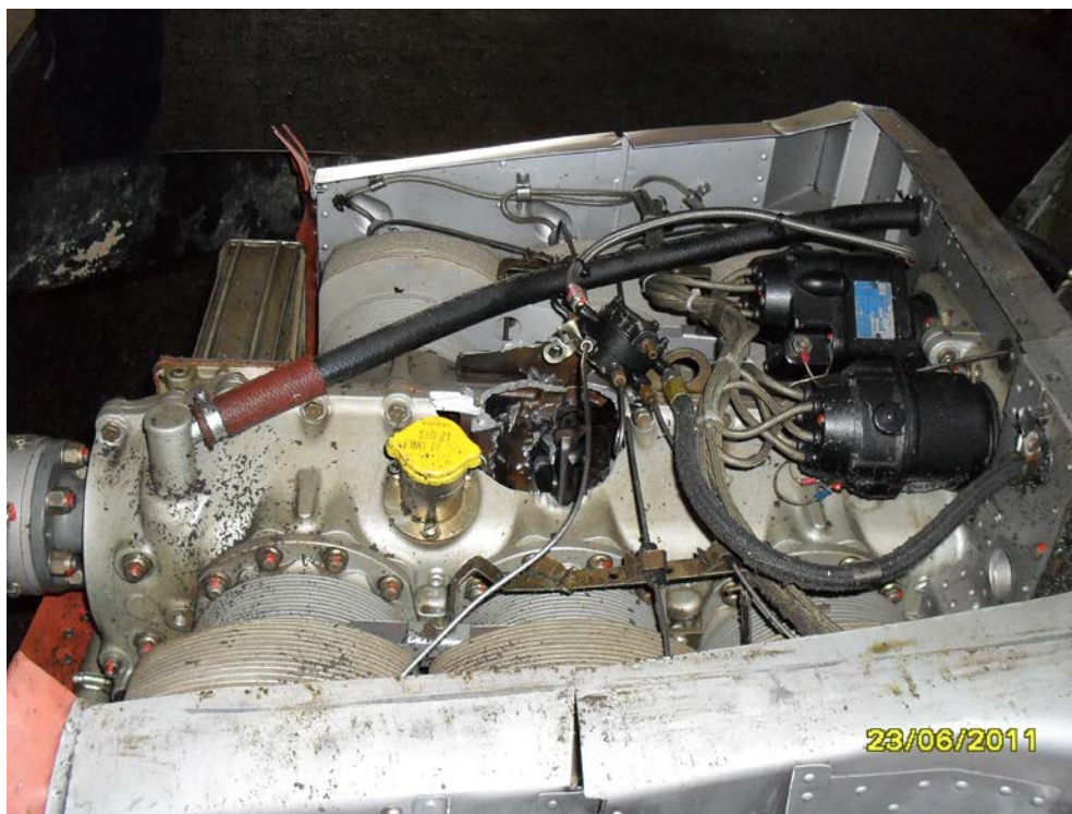
Слика 4.1 - Изглед спољашњих оштећења на мотору CONTINENTAL IO-520-F, сер. бр. 291054
