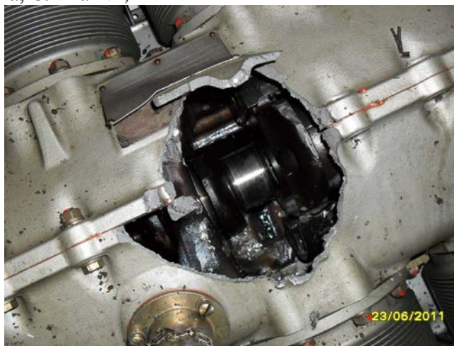
Слика 4.2 – Изглед оштећења кућишта мотора CONTINENTAL IO-520-F, сер. бр. 291054
