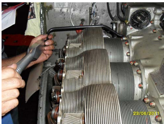
Слика 4.6 – Провера прописаних момената навртки цилиндара мотора CONTINENTAL IO-520-F, сер. бр. 291054
