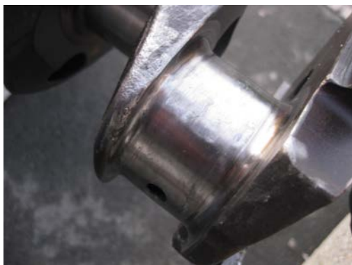
Слика 4.11 – Оштећења на 4. колону коленастог вратила
