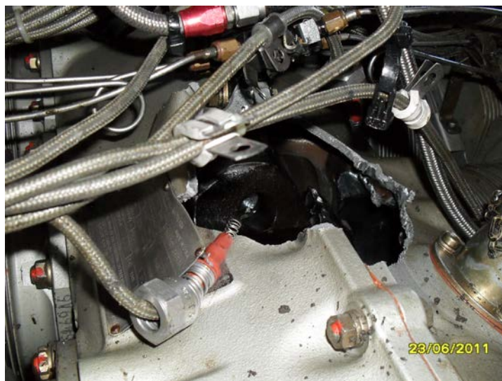
Слика 4.4 – Изглед оштећења везе дистрибутера горива и горивних цевчица са деловима кућишта
