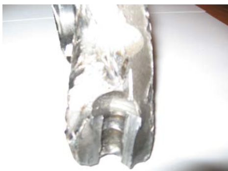
Слика 4.12- Отисак вијка на полутки
