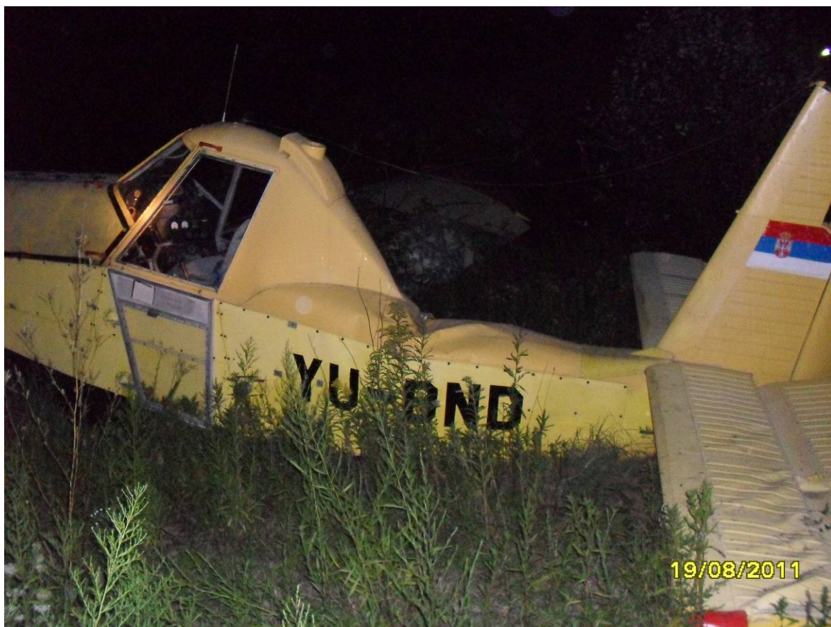
Неоштећена пилотска кабина без пилотског GPS-а.
