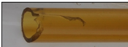
Слика 2.4.4.3. Оштећење мерне цевчице
