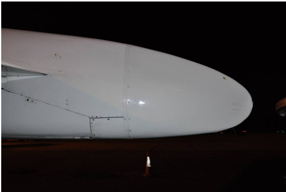
Фотографија 2 - Носач закрилца десног крила ваздухоплова 4O-AOM, десни профил
