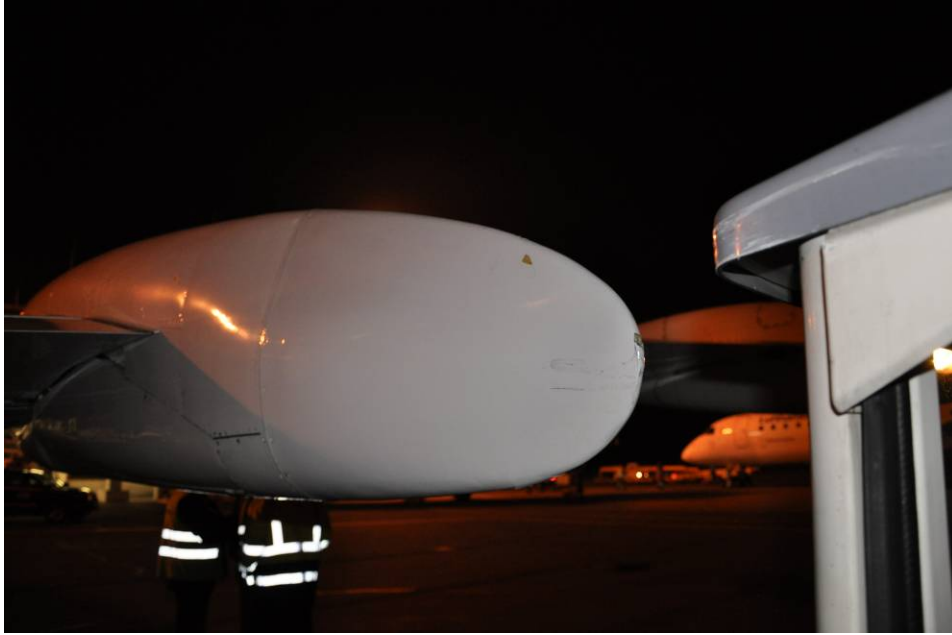
Фотографија 3 - Носач закрилца десног крила ваздухоплова 4O-AOM, са предње стране
