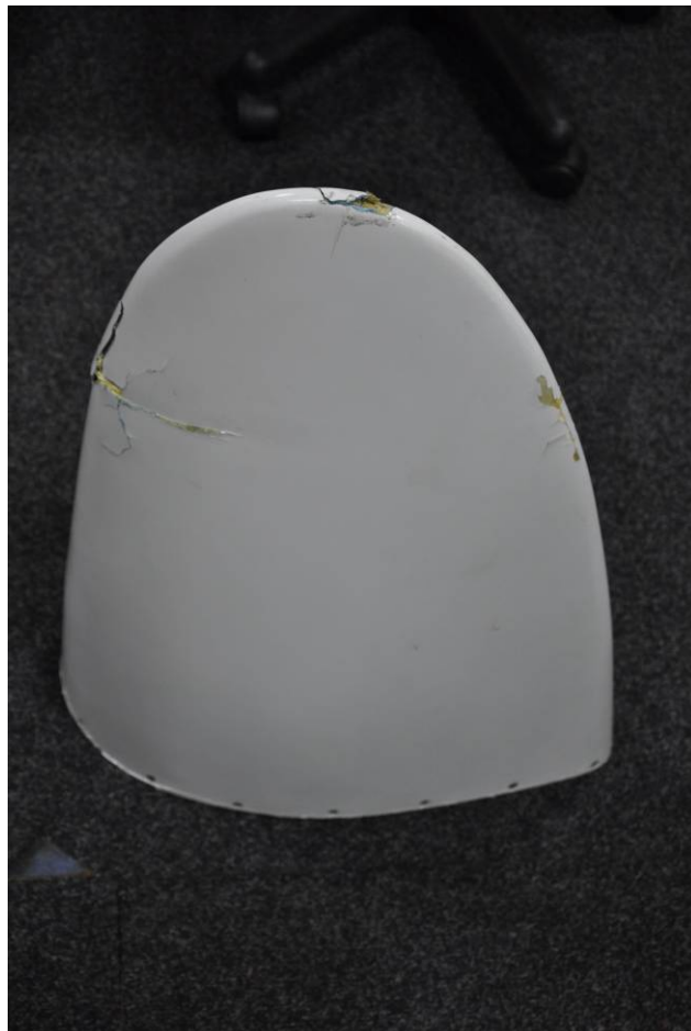
Фотографија 4 – Оштећење носача закрилца са спољашње стране снимљено након демонтаже
