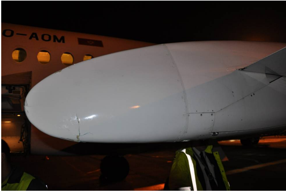
Фотографија 1 - Носач закрилца десног крила ваздухоплова 4O-AOM, леви профил
