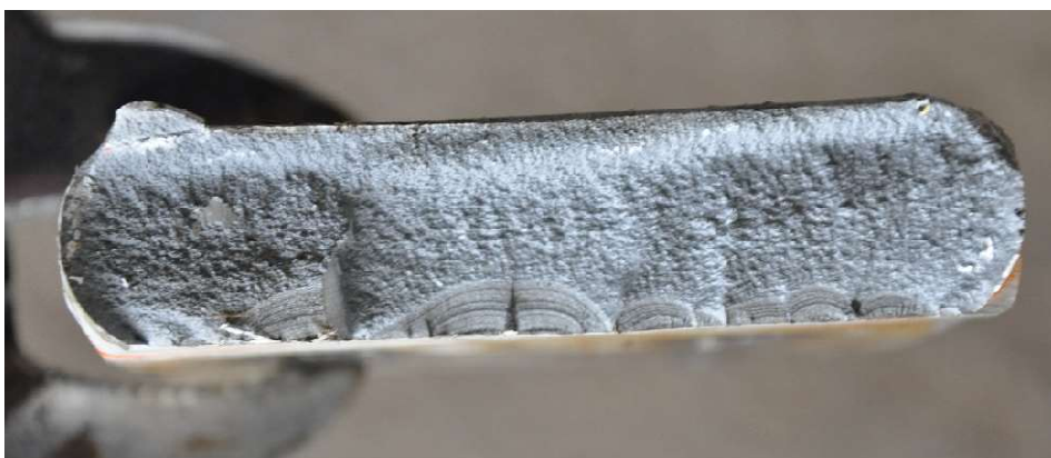
Слика 10. Попречни пресек лома равног дела ноге стајног трапа
