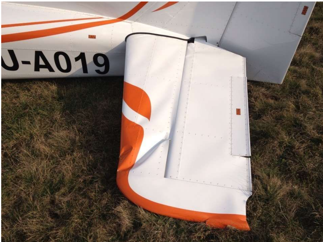
Слика 2. Оштећење хоризонталног стабилизатора
