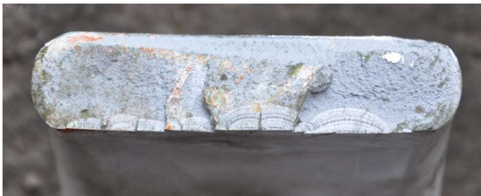
Слика 9. Попречни пресек лома савијеног дела ноге стајног трапа
