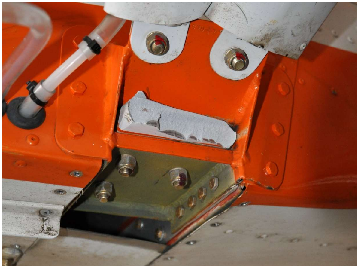
Слика 7. Део леве ноге главног стајног трапа везан за труп авиона.
