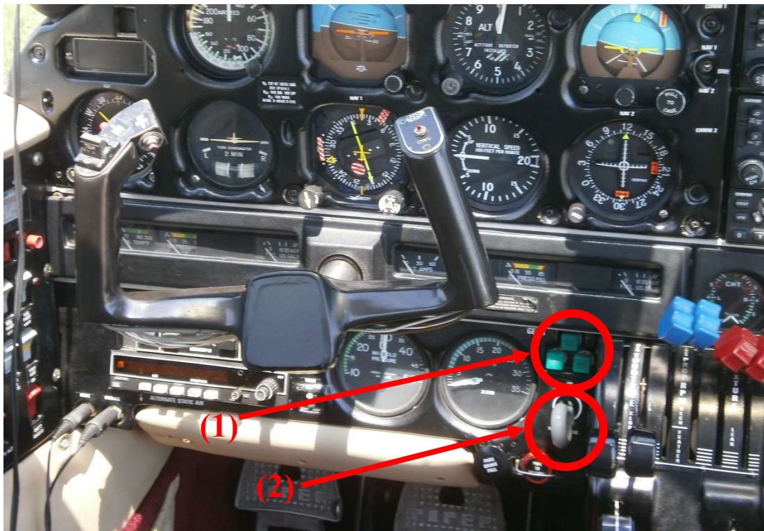
Слика 9. Положај светлосне индикације извучености стајног трапа (1) и ручице за команду извлачења/увлачења стајног трапа (2)
