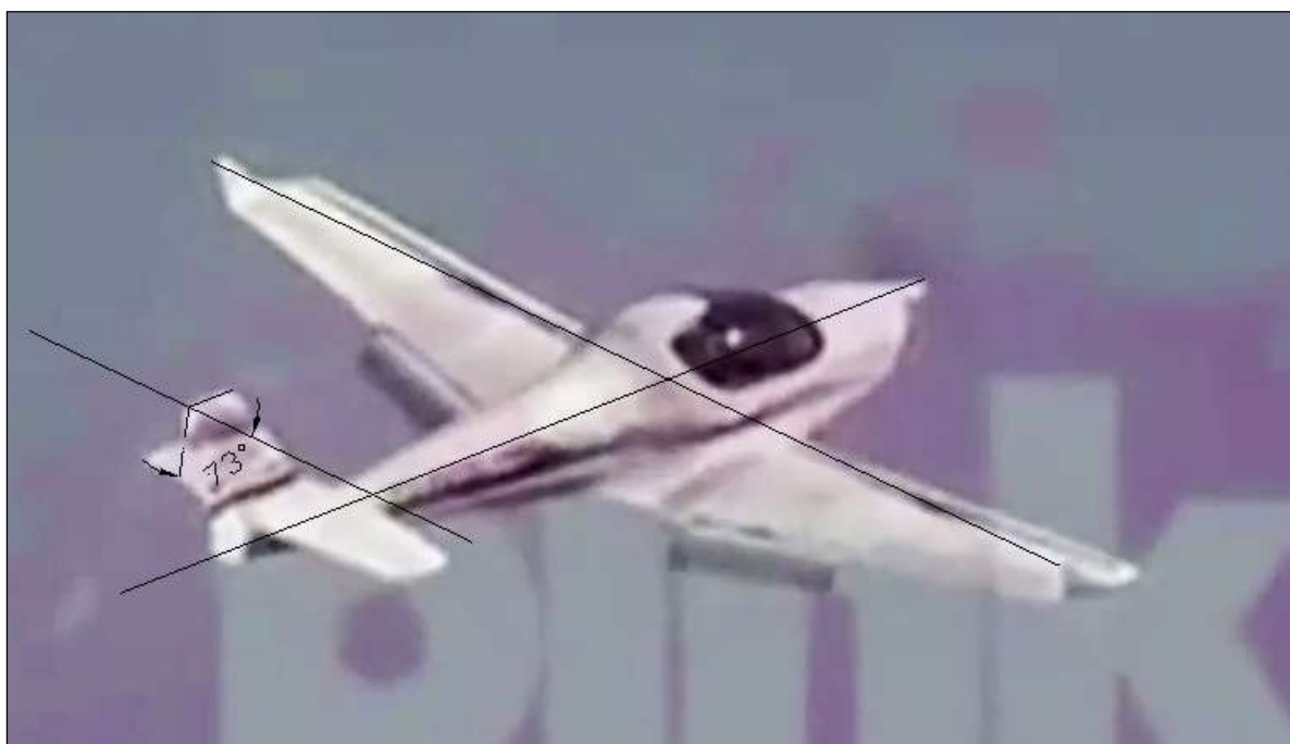
Слика 6: Пример мерења угла отклона крмила правца случај са слике 9
