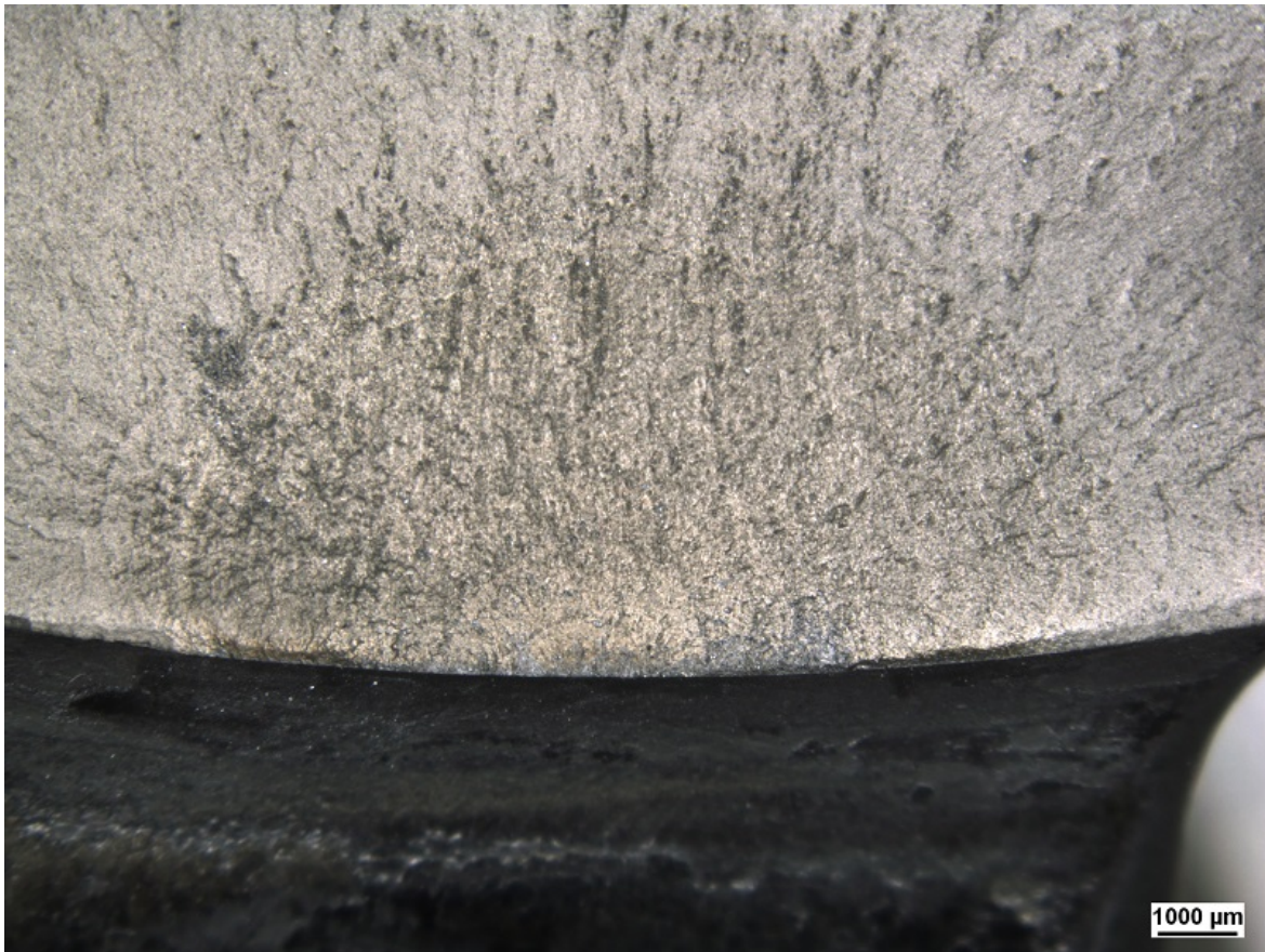
Слика 10 (део поломљеног корена лопатице где се види динамика лома)
