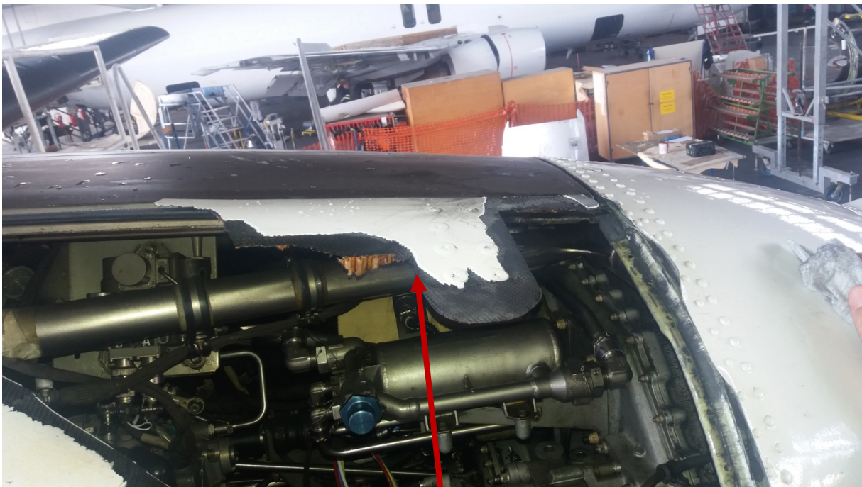
Оштећење горњег поклопца мотора бр. 1 Слика 4.
