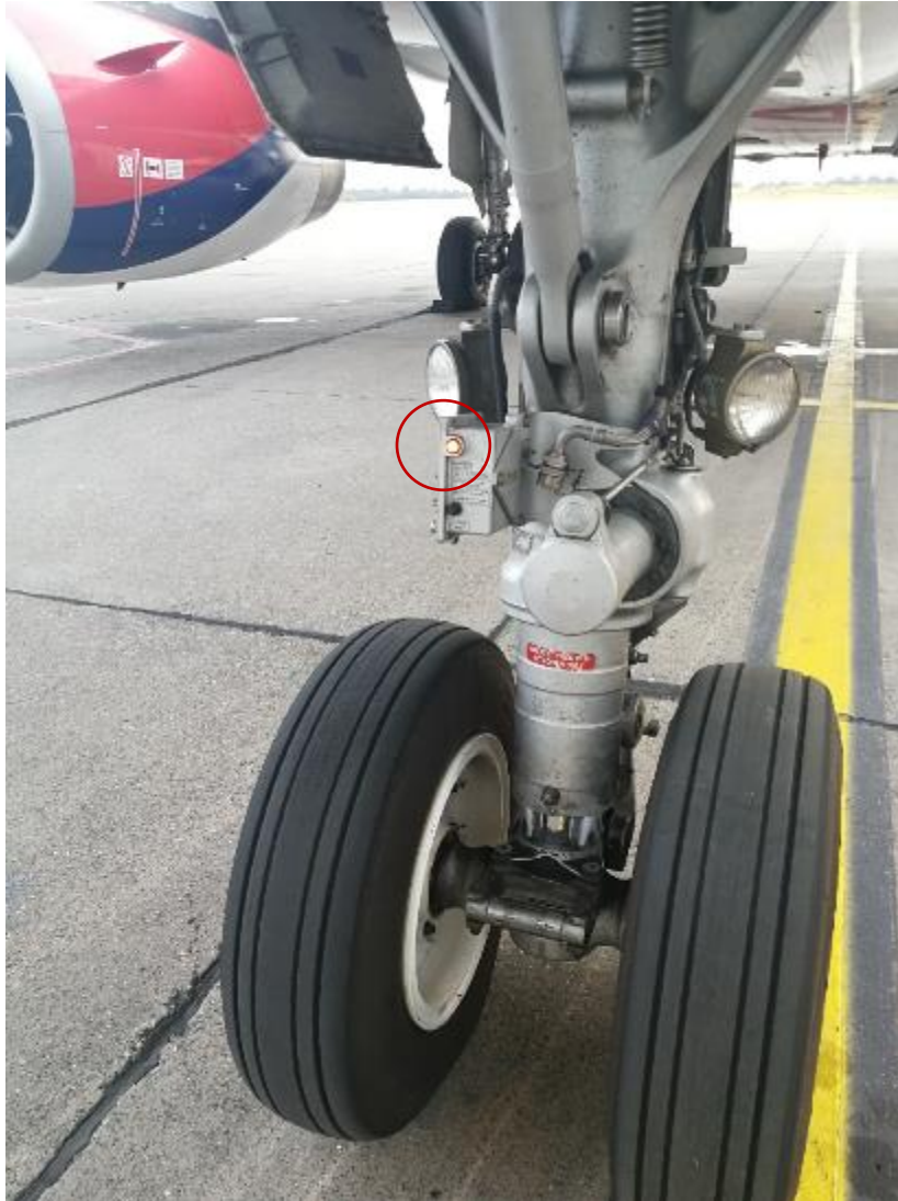
Слика 11. Светлосна сигнализација да је паркинг кочница укључена
