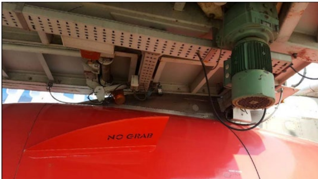
Слика 10. Судар авиона са авио-мостом – поглед одоздо
