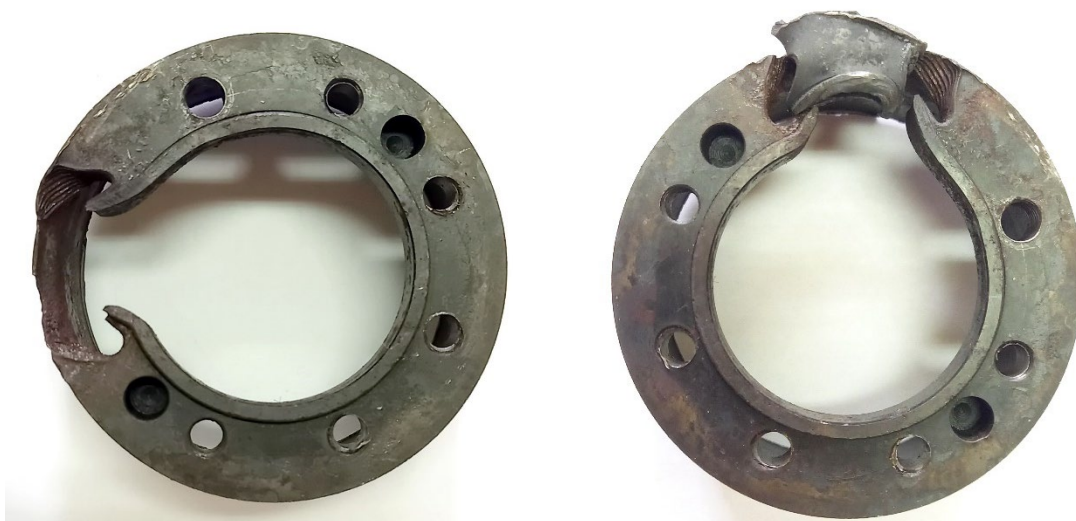
Слика 14. Вратило турбине мотора- лом
