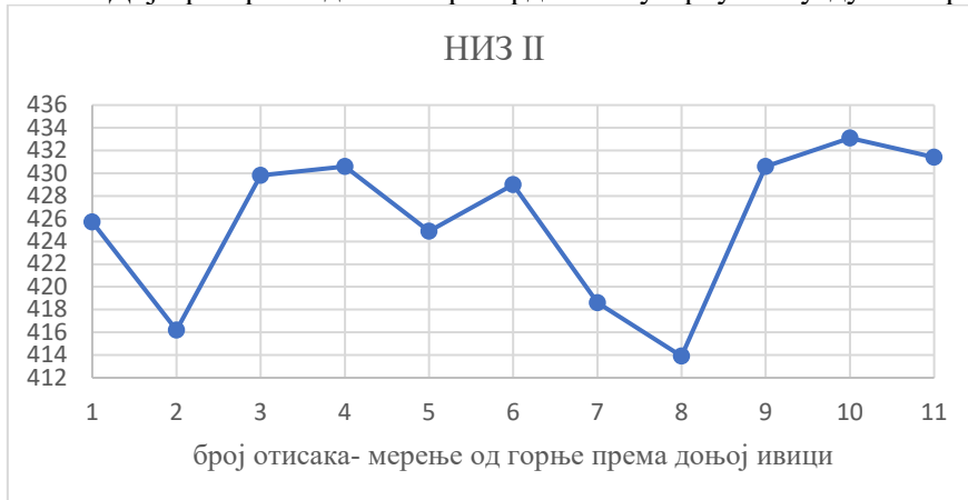
Слика 41. Дијаграм расподеле микротврдоће на узорку А1- попречни правац
