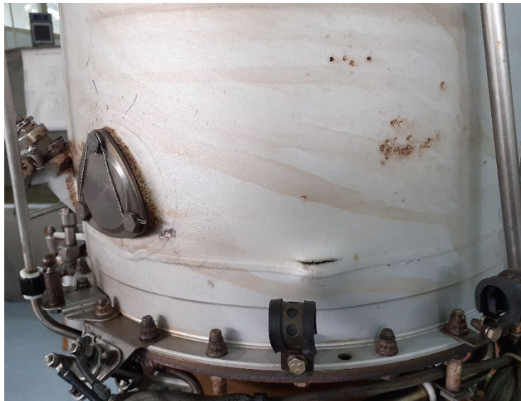
Слика 3 б. Оштећење на оплати коморе сагоревања
