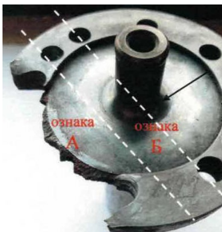
Слика 9. Коло за убризгавање – прелом
