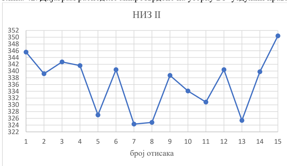
Слика 43. Дијаграм расподеле микротврдоће на узорку Б1- попречни правац
