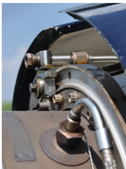
Слика 7. Неповратни вентил задњег лежаја мотора одвојен од врха горњег носача задњег лежаја
