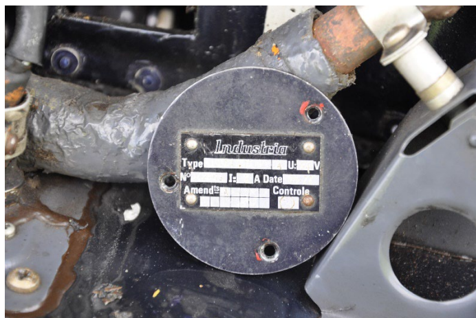
Слика 6. Оштећење – поклопац одушног вентила који је отпао са тела одушног вентила
