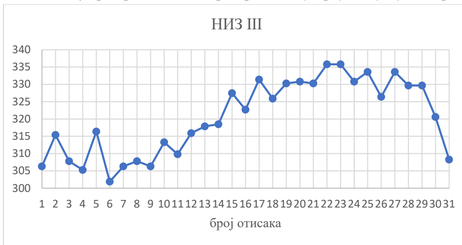
Слика 46. Дијаграм расподеле микротврдоће на узорку В1- попречни правац
