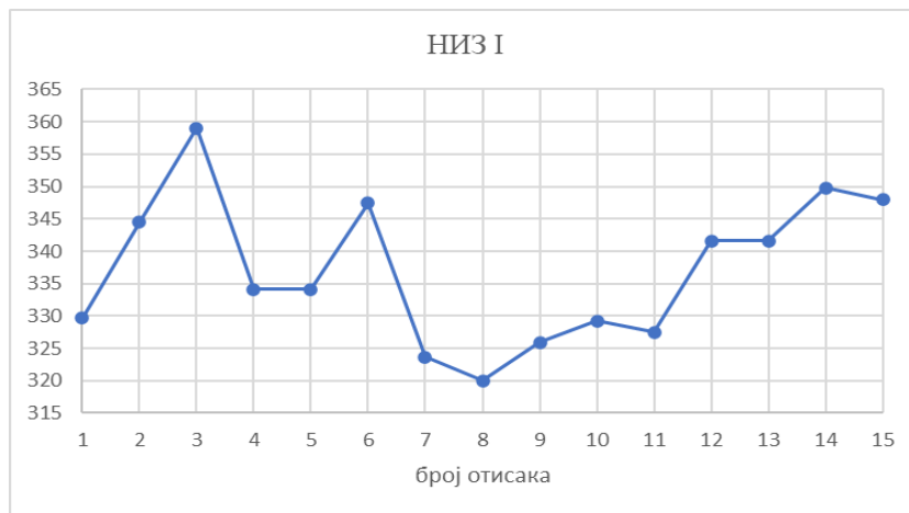
Слика 42. Дијаграм расподеле микротврдоће на узорку Б1- уздужни правац
