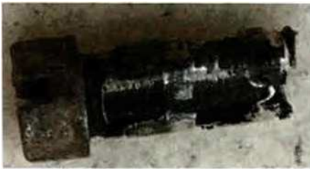
Слика 3. Поломљени шупљи вијак
