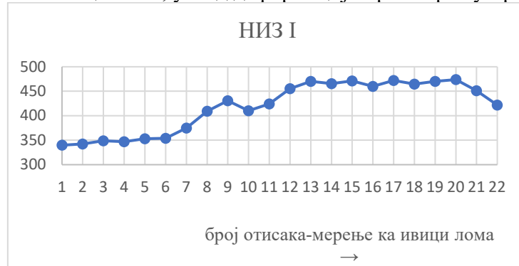
Слика 40. Дијаграм расподеле микротврдоће на узорку А1- уздужни правац
