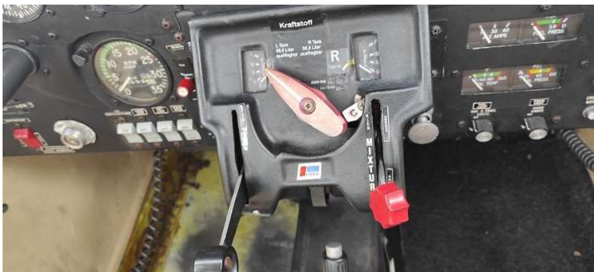
Селектор горива, подешен на леви резервоар (Слика 15)
