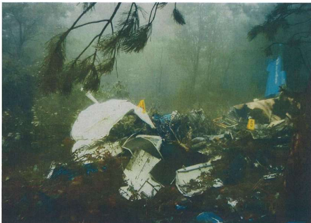
Slika broj 8.11 : Nosni dio trupa "4" i Centralni dio trupa aviona "5"
