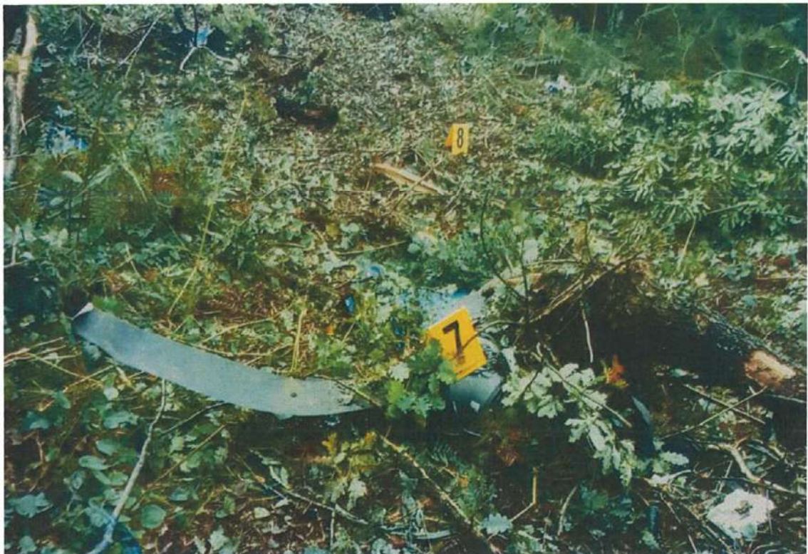
Slika broj 8.6 : Prvi kontakt trupa aviona sa zemljom "8" i elisa lijevog motora "7"
