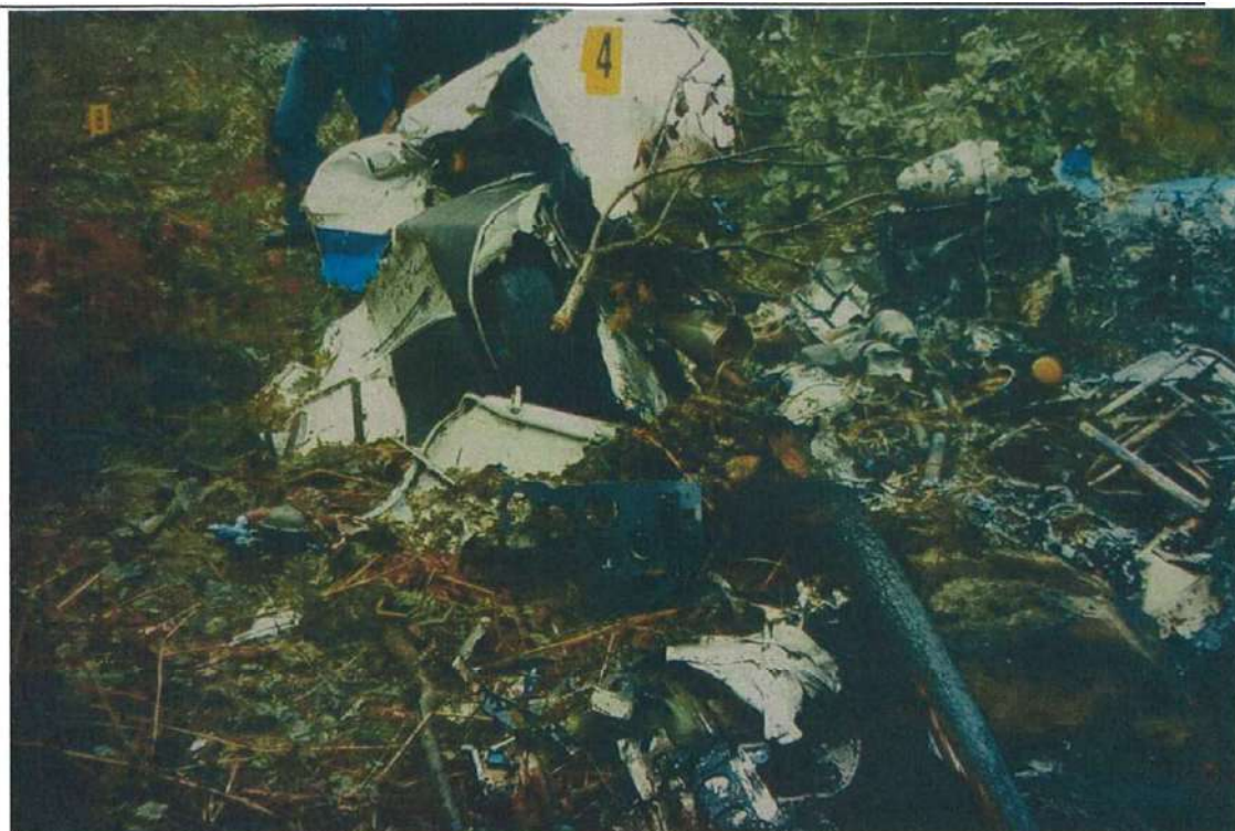
Slika broj 8.9 : Nosni dio trupa aviona sa točkom i kabina pilota "4"
