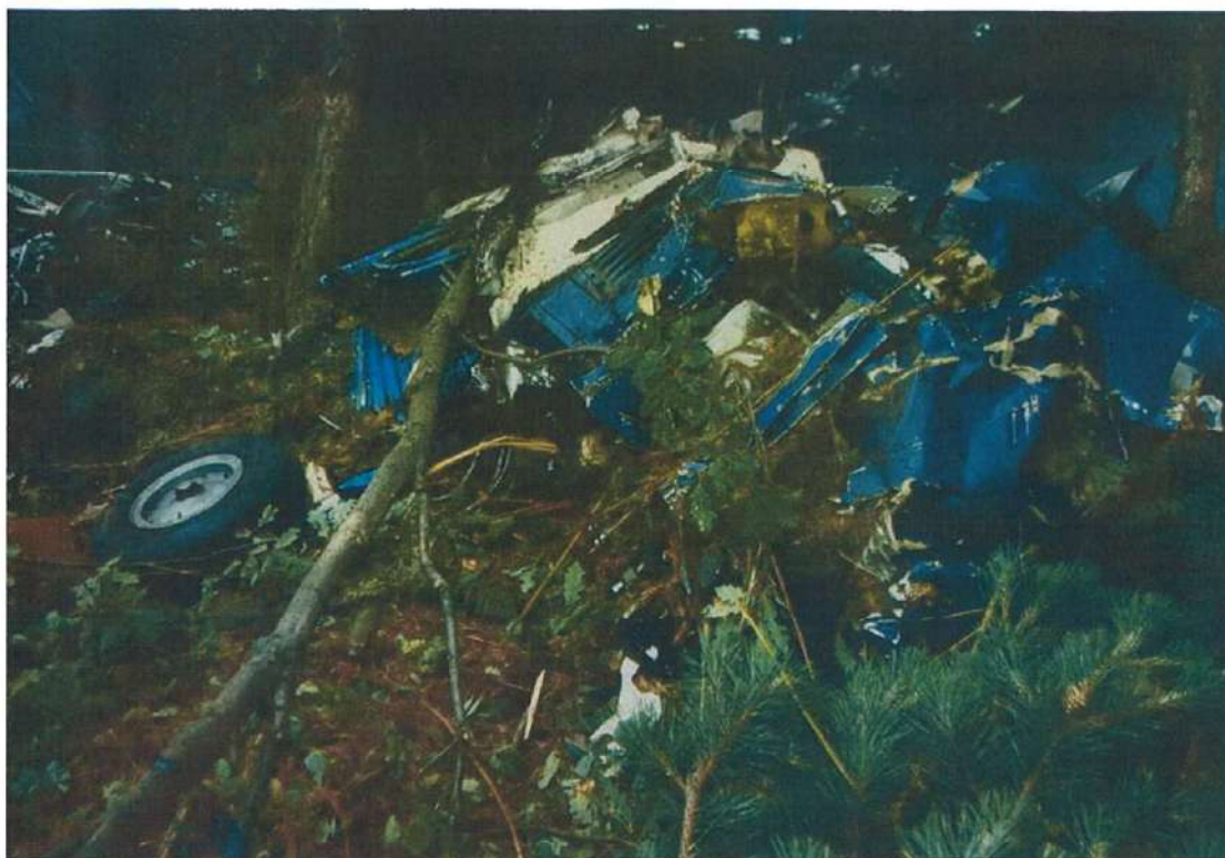
Slika broj 8.15 : Desno krilo sa motorom i desnim točak aviona
