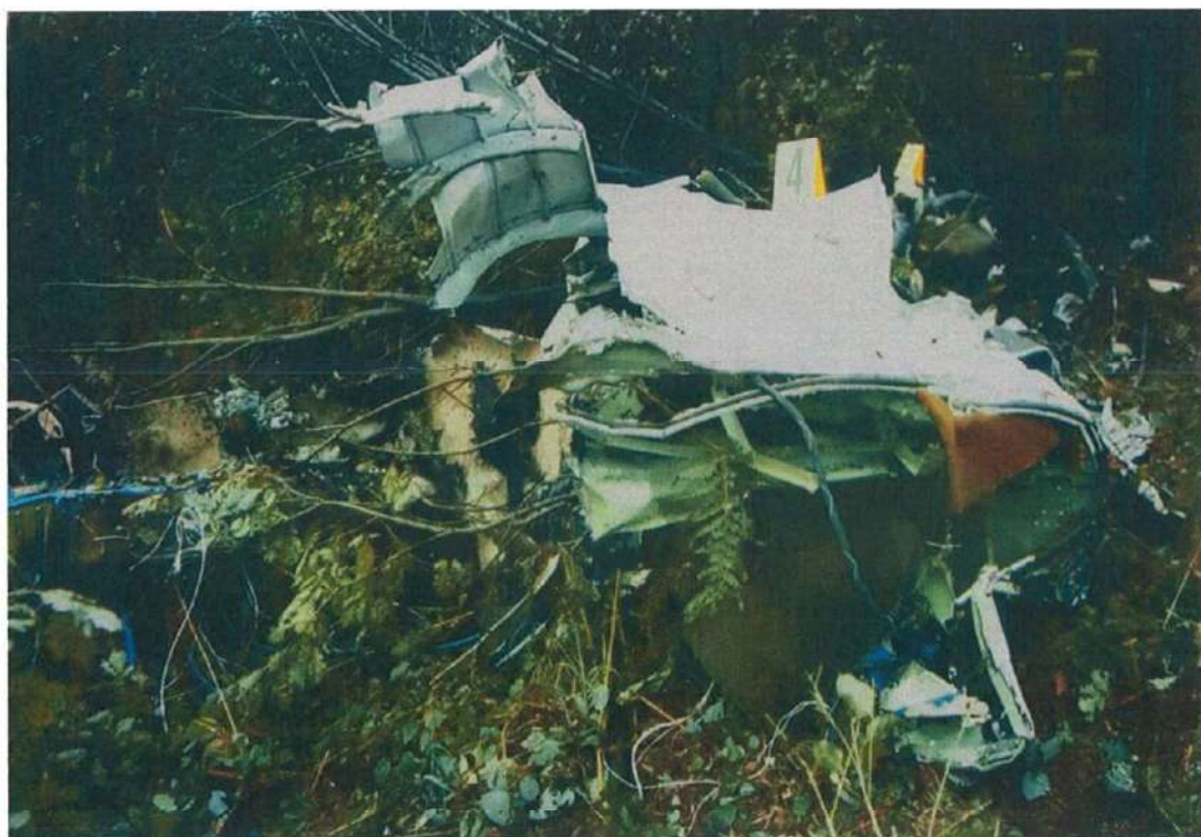
Slika broj 8.10 : Nosni dio trupa aviona i kabina pilota "4" i centralni dio trupa "5"
