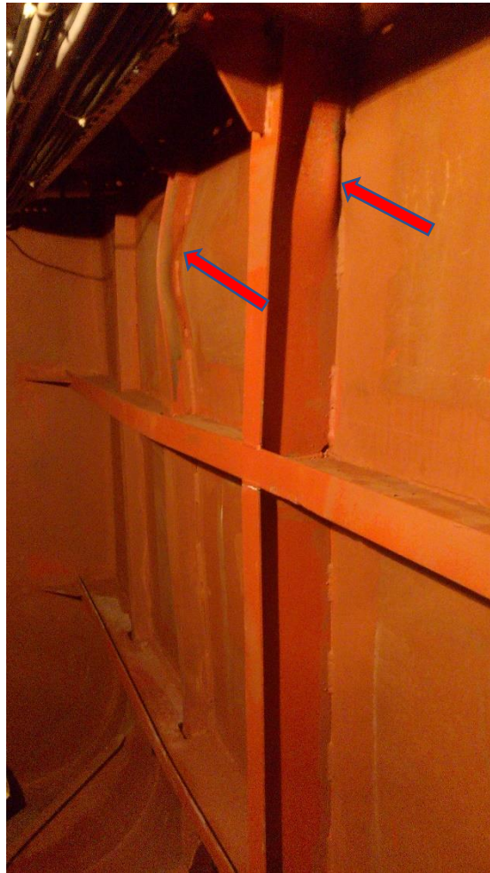
Слика 5.7.2.3. Деформације оплате, бочних ребара R26 и R27 и уздужне бочне провезе (означене стрелицама)
