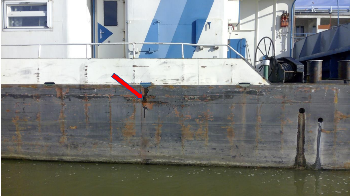
Слика 5.7.1.1. Деформација оплате на крменом делу трупа брода с/т „ДЕЛИГРАД“ (означена стрелицом)
