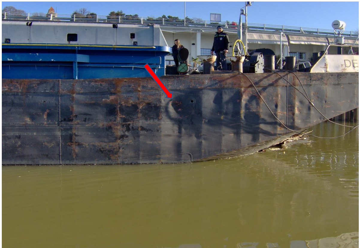
Слика 5.7.1.2. Деформација оплате на прамчаном делу трупа брода с/т „ДЕЛИГРАД“ (означена стрелицом)
