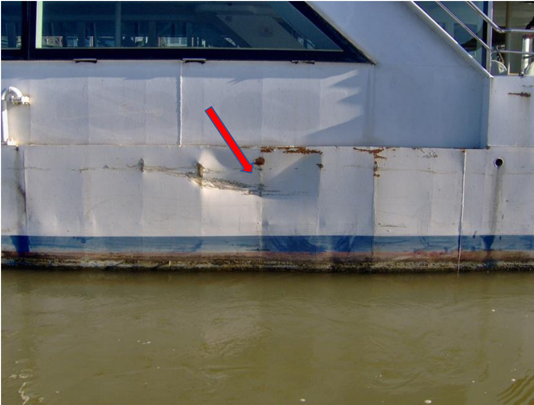
Слика 5.7.2.1. Деформација оплате трупа брода п/б „ЗЛАТНО СРЦЕ“ (означена стрелицом)
