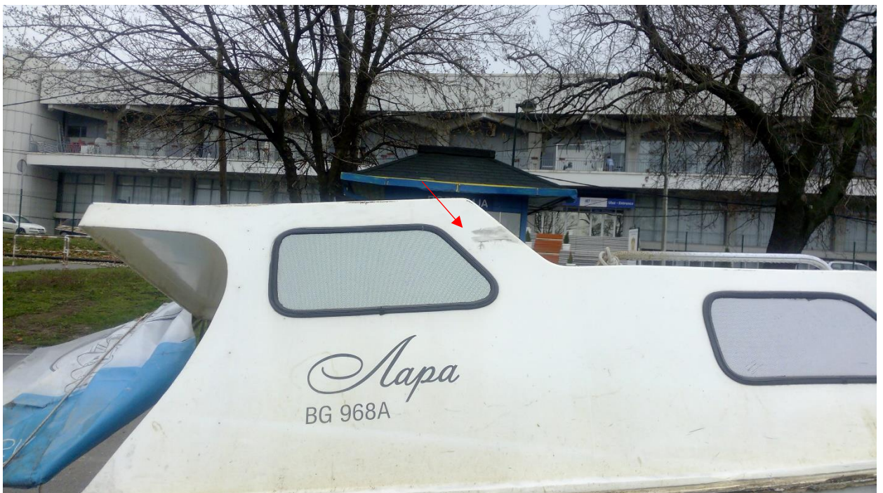
Слика 5.5.3. Траг контакта на десном боку (означено стрелицом)
