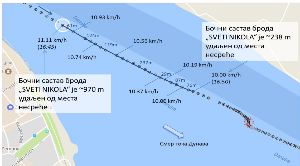
Слика 5.3.3. Промена брзине (у односу на обалу) бочног састава брода „SVETI NIKOLA“ након мимоилажења са потискиваним саставом који покреће брод м/п „MERCUR 207“
