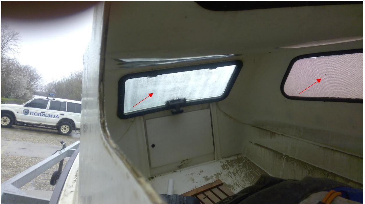
Слика 6.1. Залепљена фолија преко целе стаклене површине моторног чамца „BG-968А“
