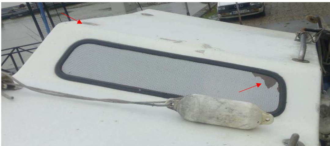
Слика 5.5.1. Позиција недостајућег рукохвата и оштећена залепљена фолија на стакленој површини на предњој страни чамца (означено стрелицама)
