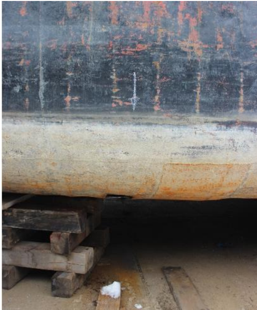
Слика 4.13. Обележена зона истрошености оплате и продора ради узимања узорка
