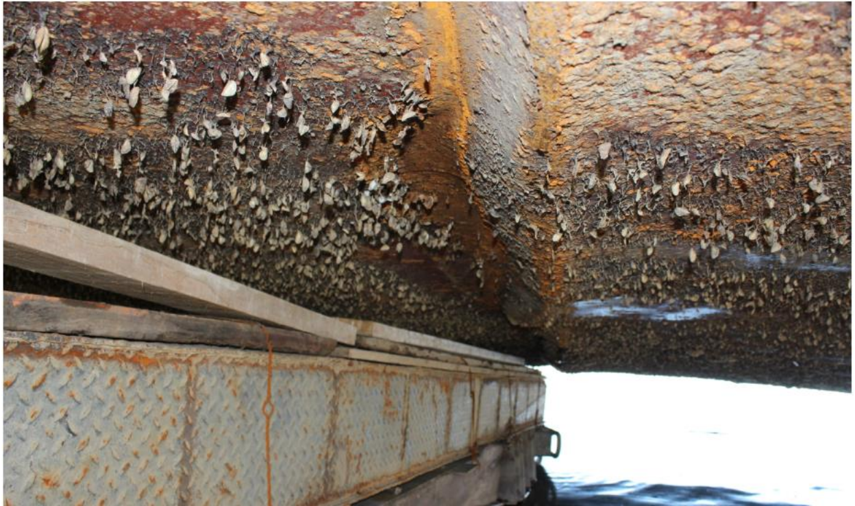
Слика 4.9. У зони средњег дела трупа брода прелом, простире се дијагонално између ребара 54 и 55
