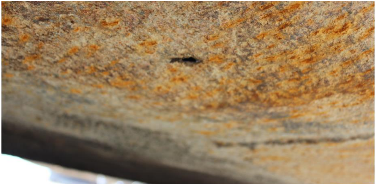
Слика 4.12. Продор због истрошености лима оплате брода
