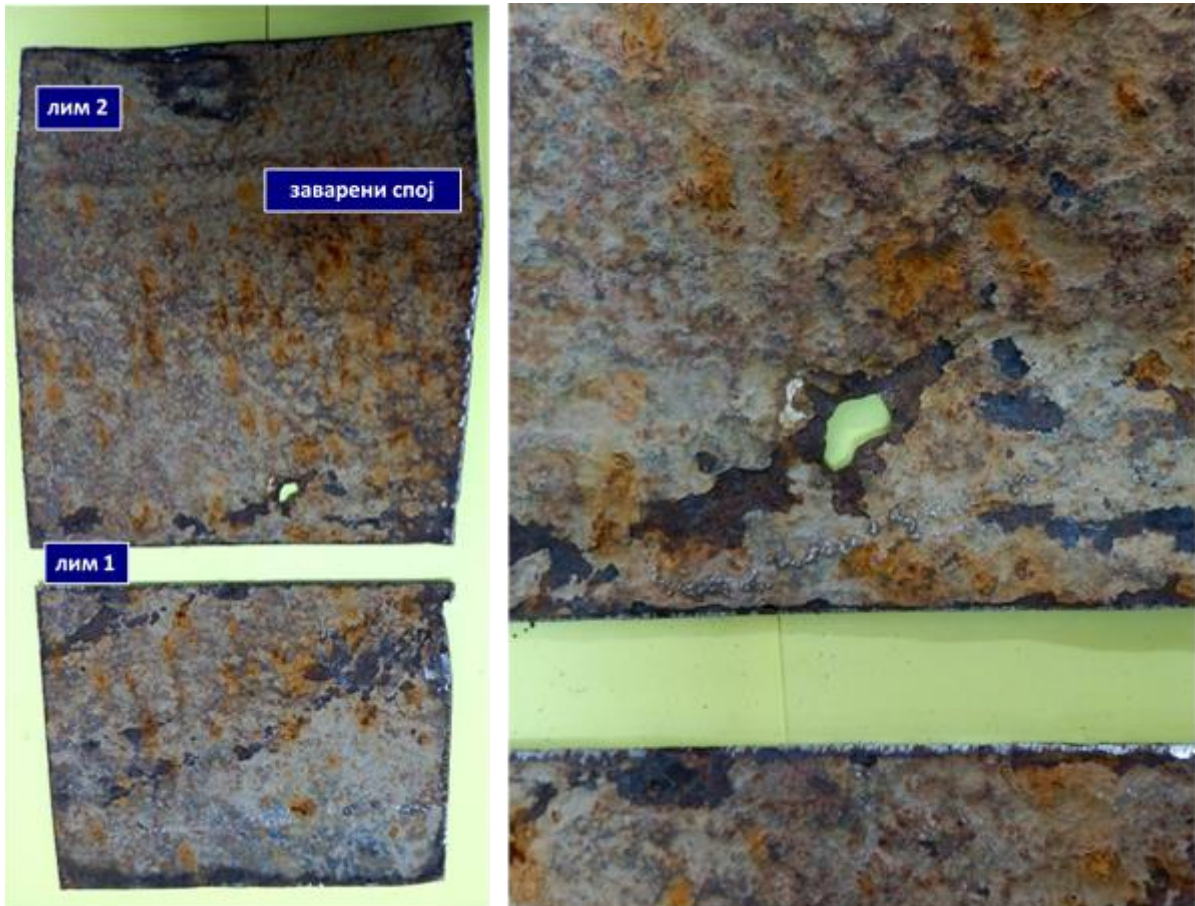
Слика 9. Макрофотографије исеченог узорка са оштећењем (рупом) са спољашње стране.
