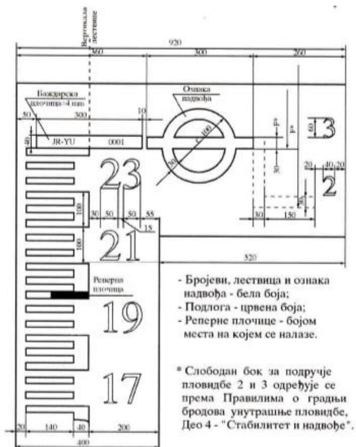
Слика 4.4. Баждарска лествица на средини дужине брода са ознаком за надвође, баждарском плочицом и реперним плочицама
