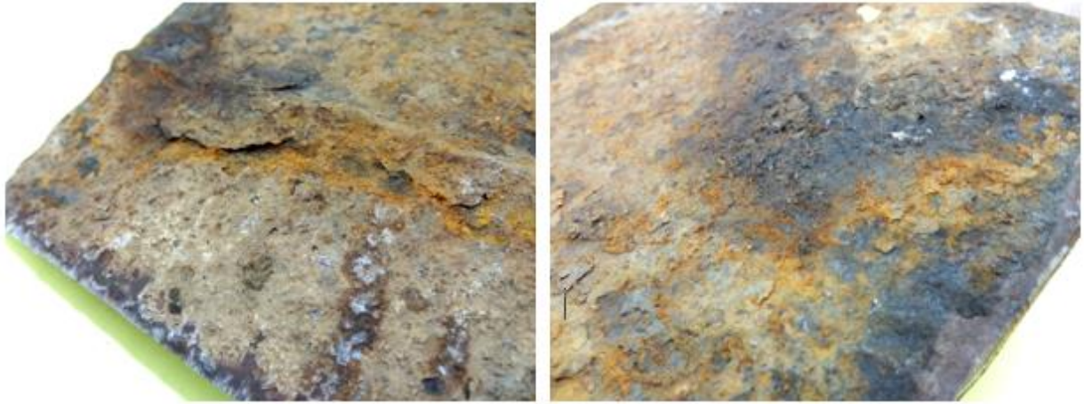
Слика 8. Макрофотографија корозионих оштећења и корозионих наслага са унутрашње стране у околини завареног споја лимова 1 и 2 - слика лево (види слику 4) и у околини рупе - слика десно (види слику 6).
