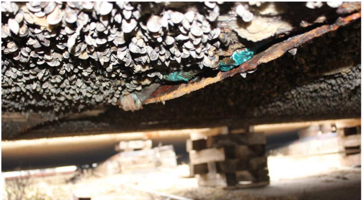
Слика 4.16. Отворена пукотина оплате дна у зони уздужнице брода, на дну трупа у правцу лома
