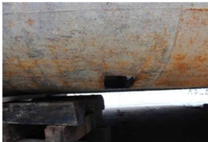
Слика 5. Позиција исеченог узорка са оштећењем (рупом) у првом складишту иза прамчаног пика, у лиму узвоја, између ребара 37 и 38 (макрофотографије са спољашње стране)
