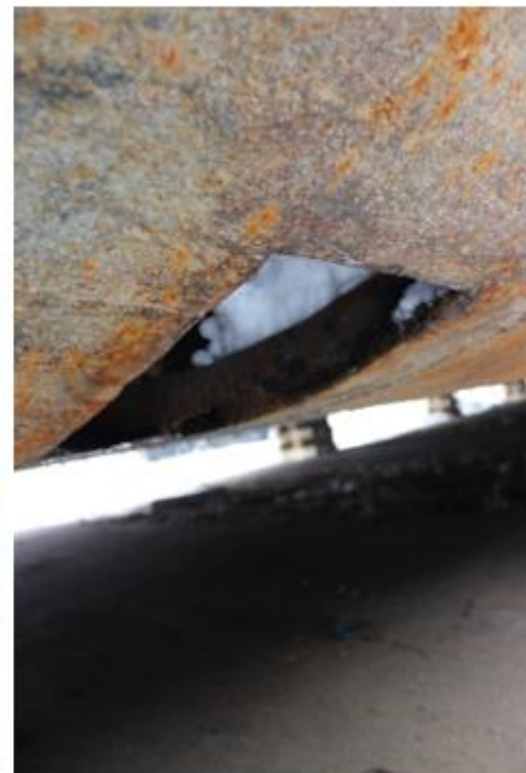
Слика 5. Позиција исеченог узорка са оштећењем (рупом) у првом складишту иза прамчаног пика, у лиму узвоја, између ребара 37 и 38 (макрофотографије са спољашње стране)
