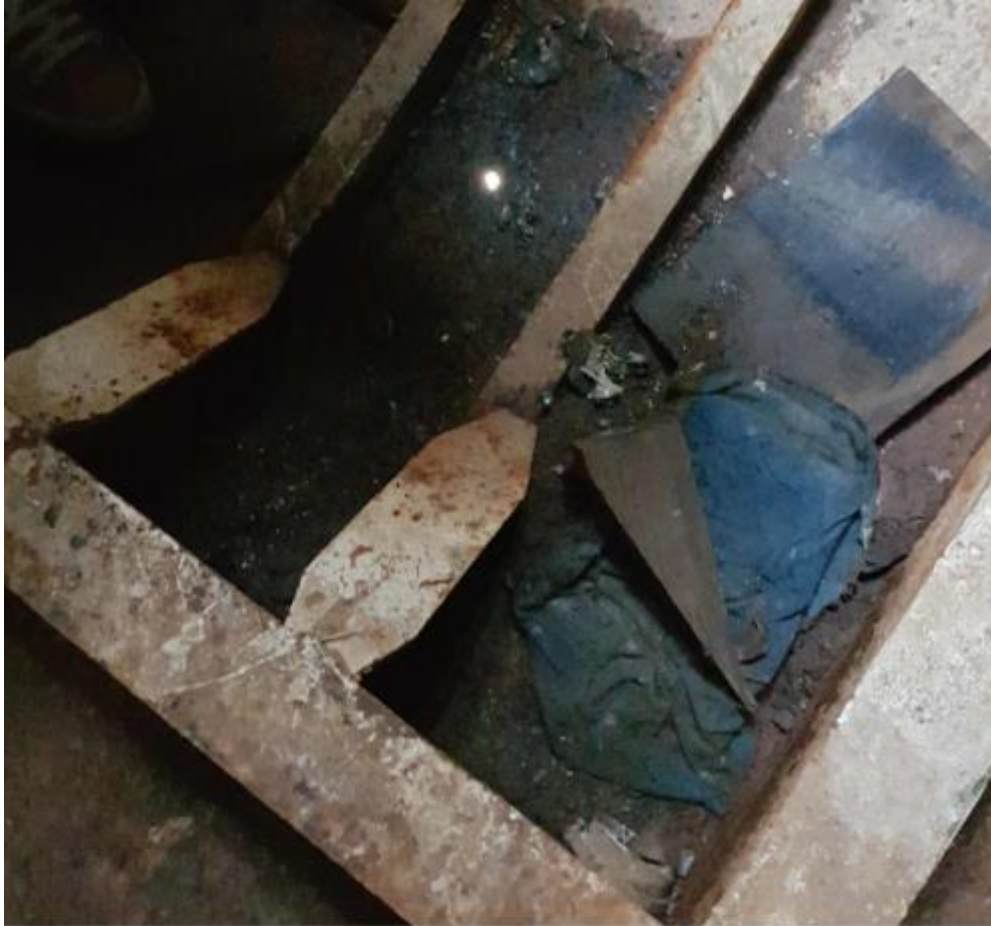
Слика 4.11. Масни бал у сувом простору број I, на прамцу, на узвоју левог бока
