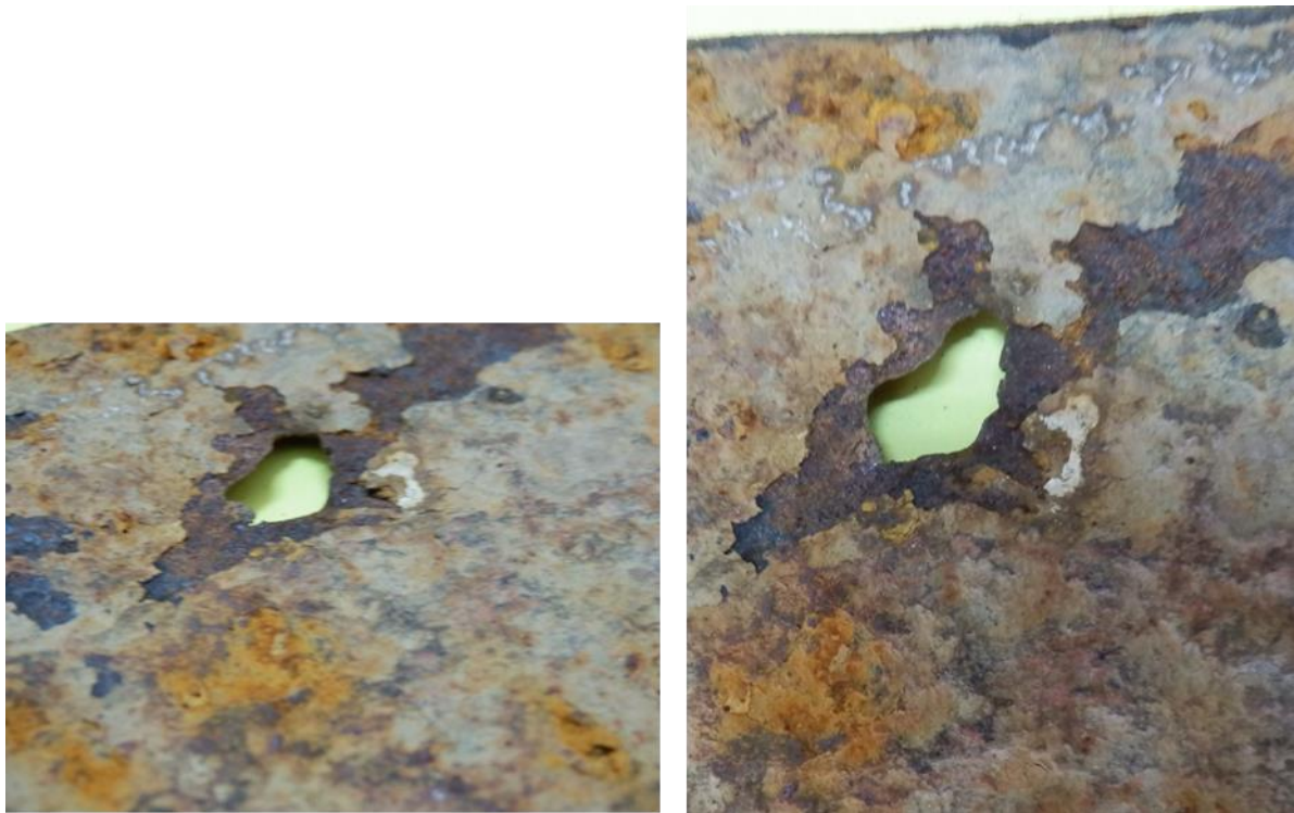
Слика 10. Макрофотографије оштећења (рупе) са спољашње стране.
