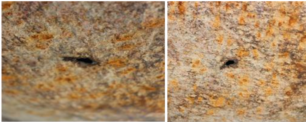
Слика 3. Оштећења (рупа) у првом складишту иза прамчаног пика, у лиму узвоја, између ребара 37 и 38 (макрофотографије са спољашње стране)
