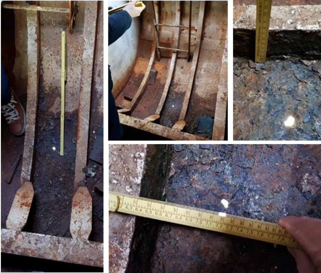
Слика 2. Оштећења (рупа) у првом складишту иза прамчаног пика, у лиму узвоја, између ребара 37 и 38 (макрофотографије са унутрашње стране)
