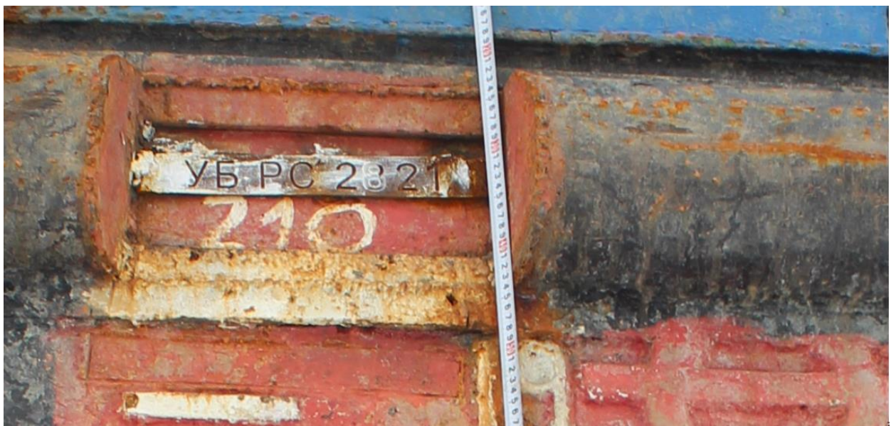
Слика 4.17. Очитан максималан гас са средње загазнице на боку брода
