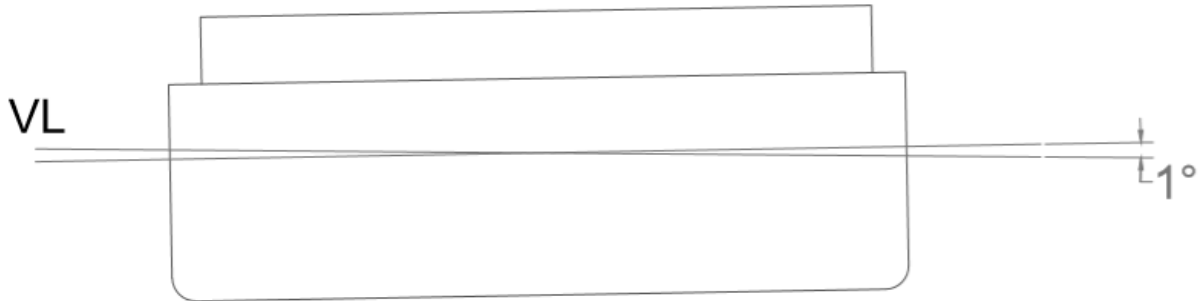
Слика 2.1.1.2. Попречни нагиб потиснице „SL 31 I” у односу на водну линију
