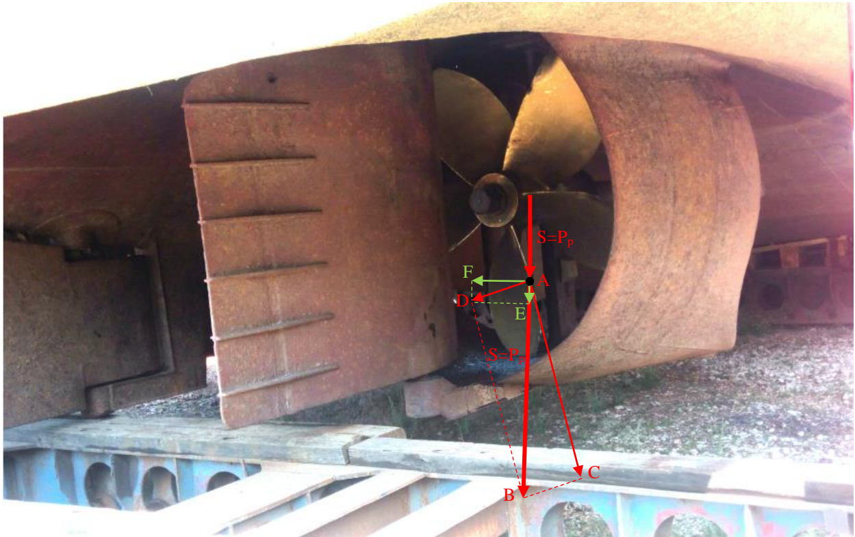
Слика 4.3. Дејство силе струјања воде-пропулзиона сила ( S=P_p ) на главна пера крме брода
