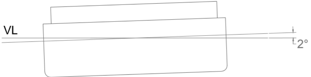
Слика 2.1.2.2. Попречни нагиб потиснице „МНРТ 1815-В“ у односу на водну линију
