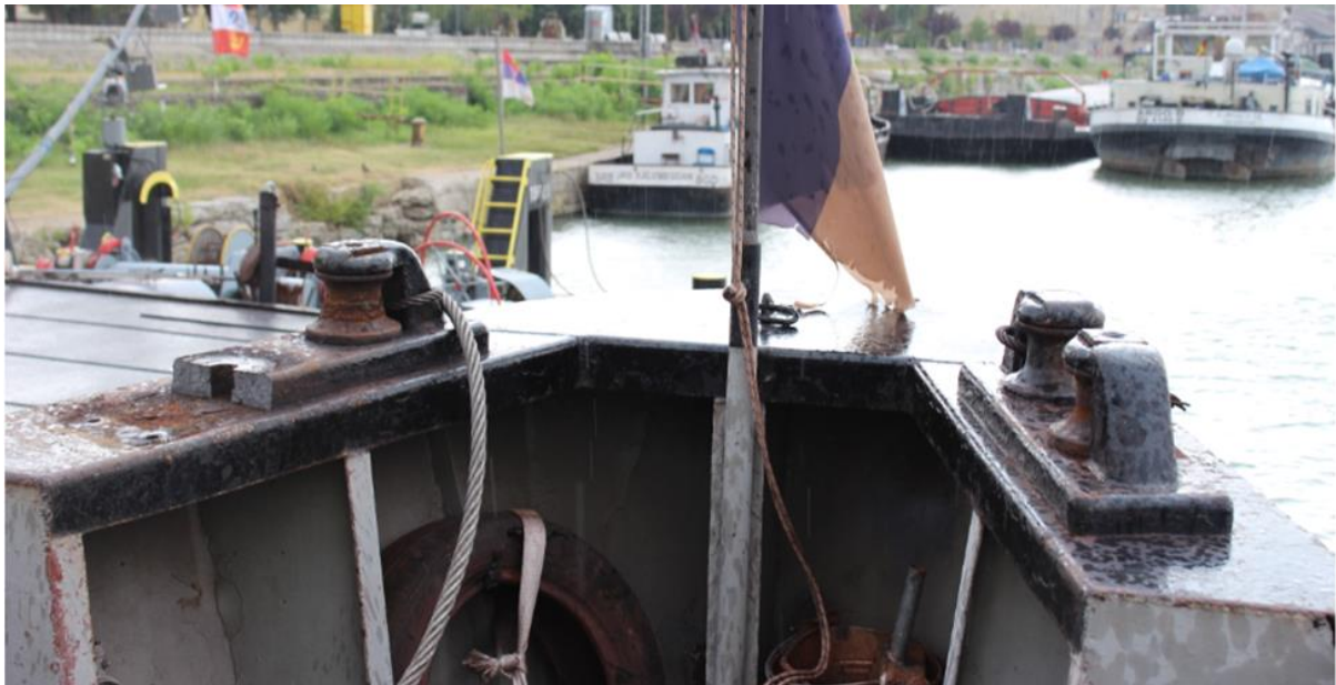
Слика 3.4.2. Оштећена лева прамчана зевача на броду м/т „GAGRA“
