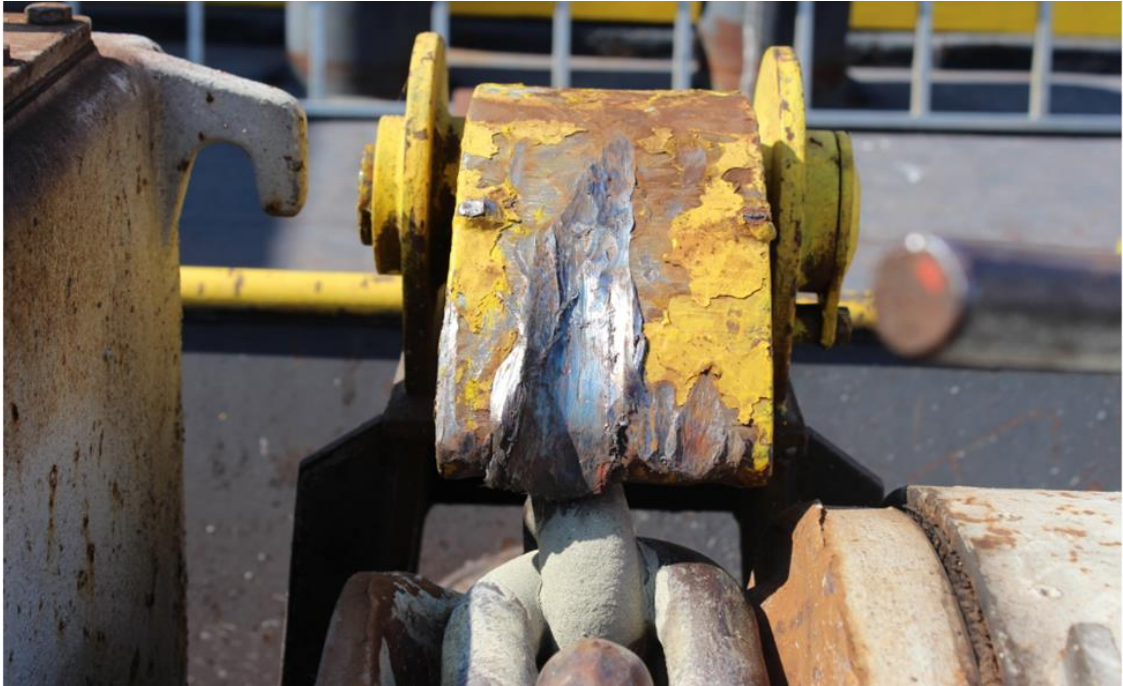
Слика 3.5.2. Оштећење западача (осигурач) сидреног ланца
