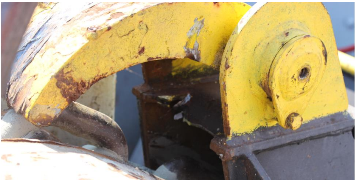
Слика 3.5.3. Деформација и оштећење виљушке западача ланца
