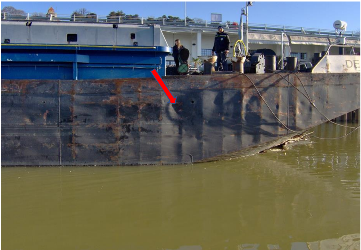
Слика 3.1.3. Деформација оплате на прамчаном делу трупа брода с/т „DELIGRAD“ (означена стрелицом)
