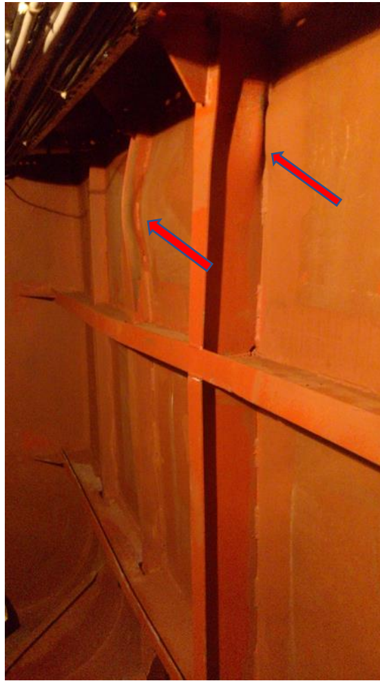
Слика 4.1.1.4. Деформације оплате, бочних ребара R26 и R27 и уздужне бочне провезе (означене стрелицама), п/б „ZLATNO SRCE“
