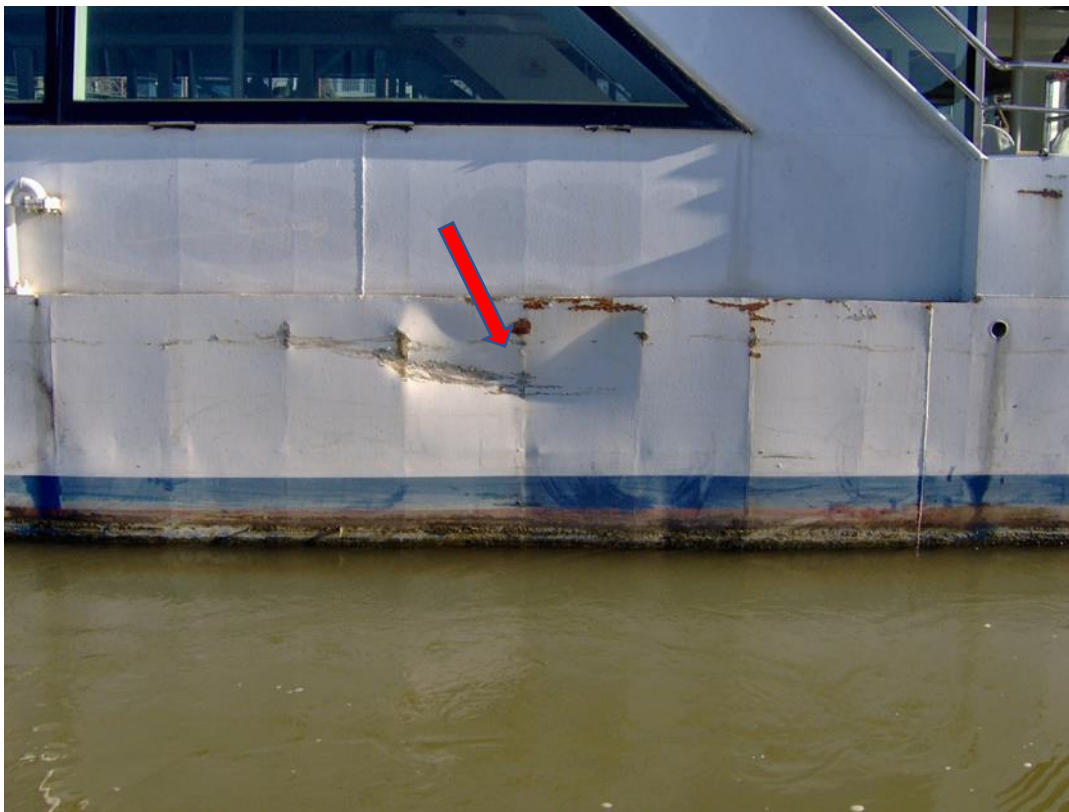
Слика 3.1.4. Деформација оплате трупа брода п/б „ZLATNO SRCE“ (означена стрелицом)
