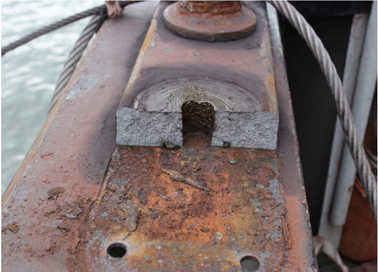
Слика 5.5. Попречни прелом тела леве прамчане зеваче на броду м/т „GAGRA“
