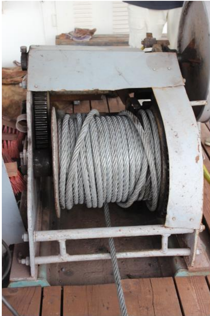
Слика 5.1. Прамчано електрично притезно витло на броду м/т „GAGRA“
