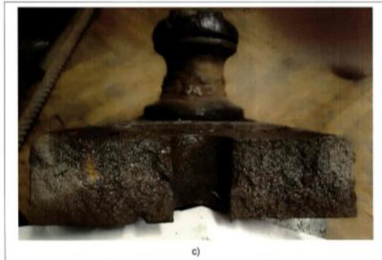
Slika 1. a) Slika polomljenog tela zevače dostavljena od strane Naručioca. b) Deo polomljenog tela zevače dostavljen u laboratoriju "IMS" na ispitivanje. c) Prelomna površina polomljenog tela zevače sa slike b).
