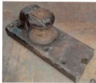
Slika 1: Izgled polomljene zevače iz koje je isečen uzorak za hemijsku analizu (bazna ploča)
