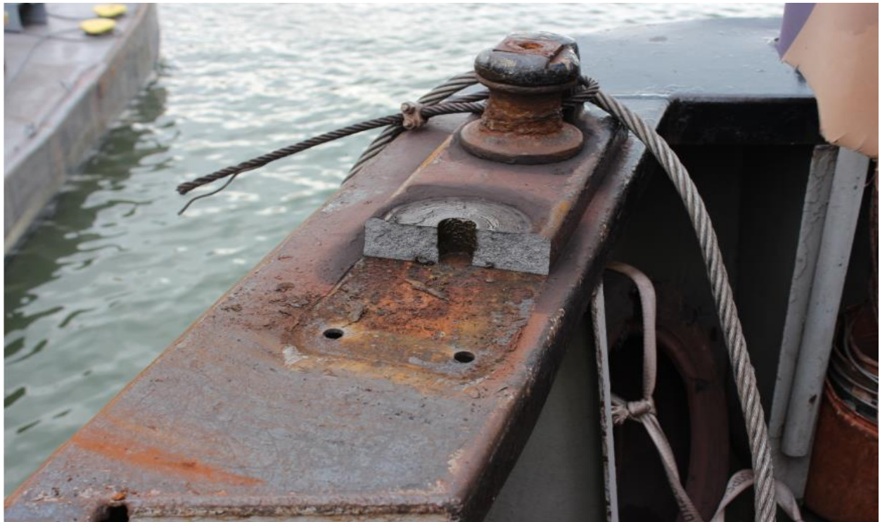
Слика 5.4. Оштећени део леве прамчане зеваче са покретним ваљком и челичним ужетом \text{Ø} 22 \text{ mm} на броду м/т „GAGRA“
