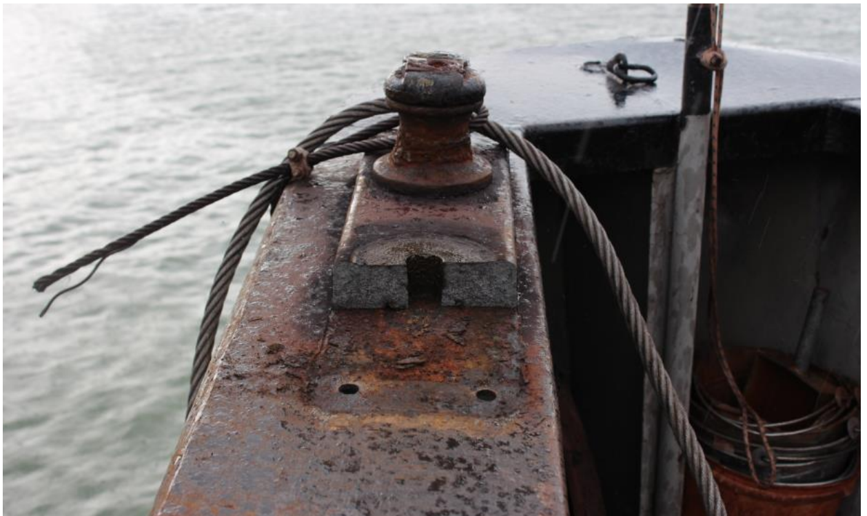
Слика 5.3. Оштећена зевача на левом прамчаном боку таласњаче брода м/т „GAGRA“
