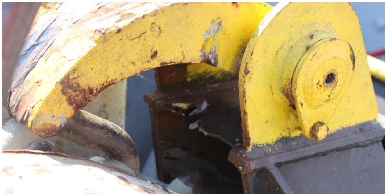
Слика 5.1.3. Деформација и оштећење виљушке западача ланца
