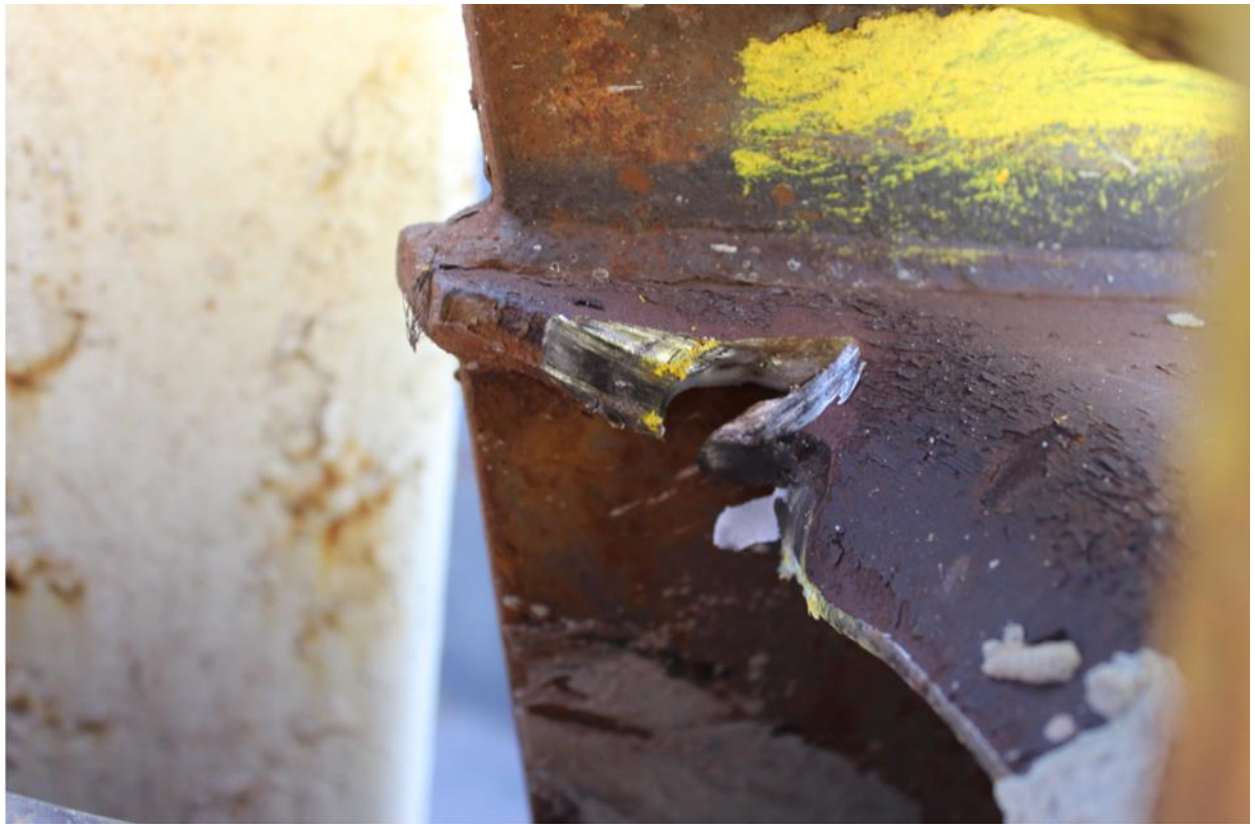
Слика 5.2.4. Пластична деформација са откинутим делом материјала виљушке (носача) осигурача ланца
