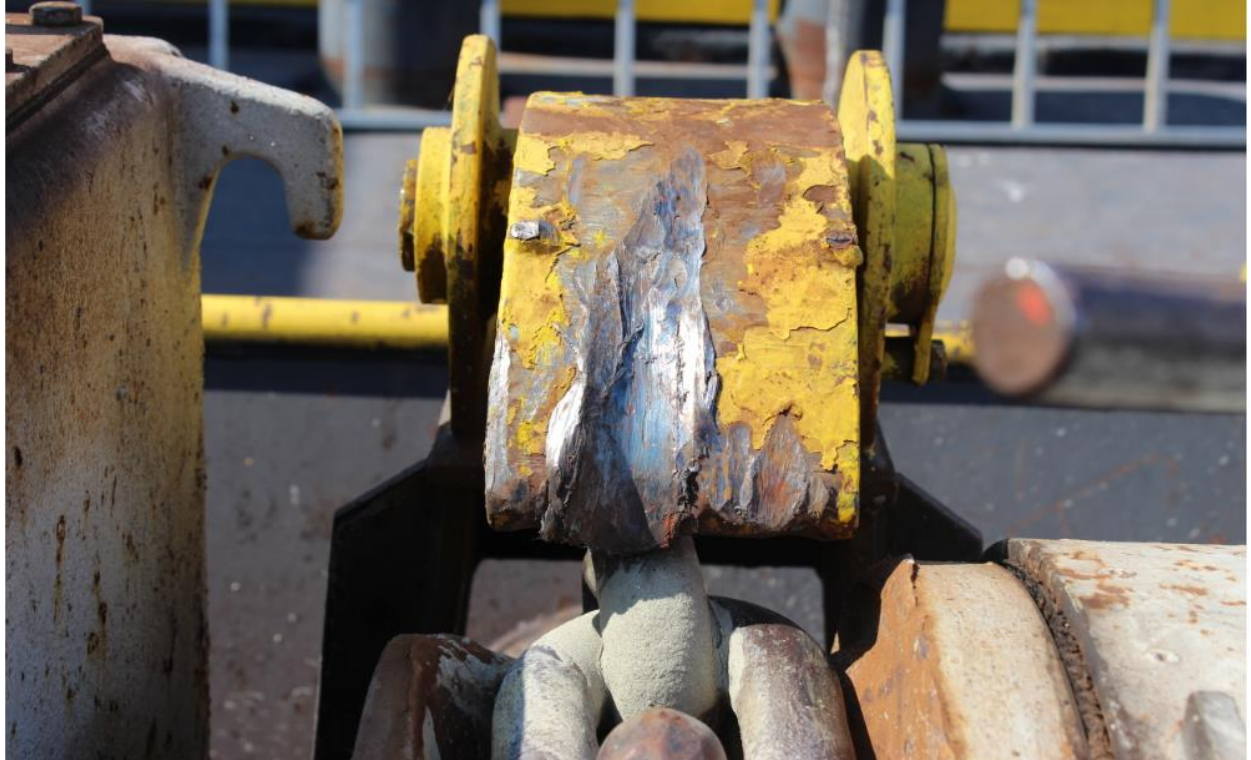
Слика 5.1.2. Оштећење западача (осигурач) сидреног ланца
