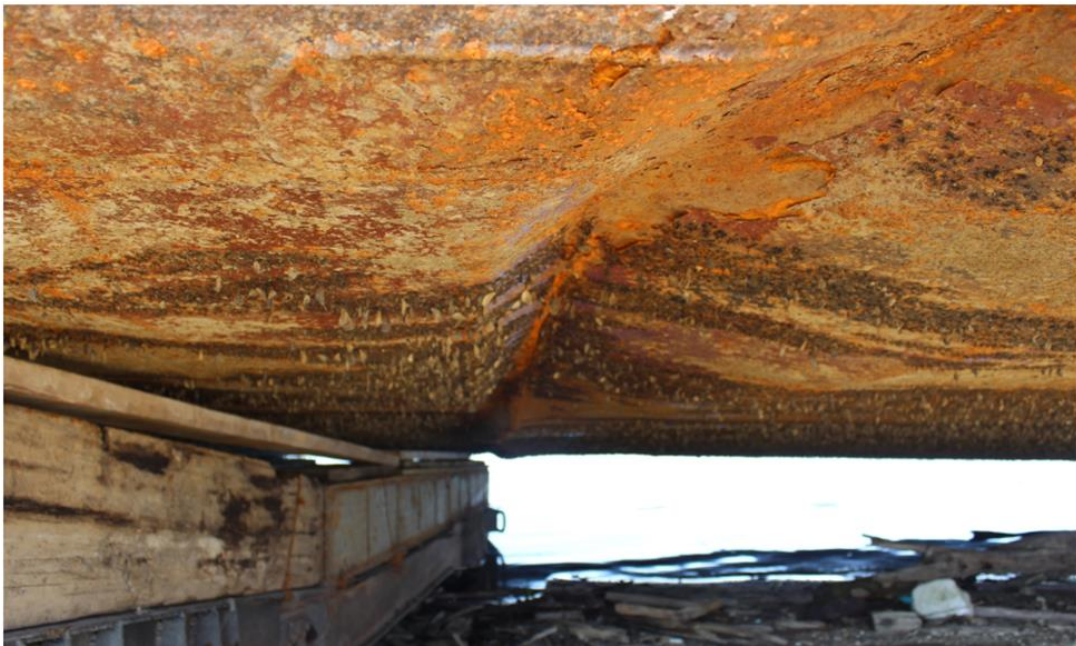
Слика 4.3.1.8. Деформација оплате по целој ширини дна (табана)
