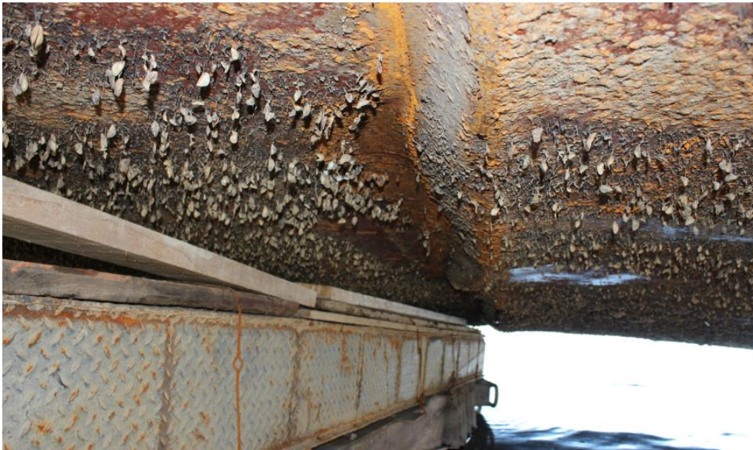
Слика 4.3.1.9. У зони средњег дела трупа брода прелом, простире се дијагонално између ребара 54 и 55
