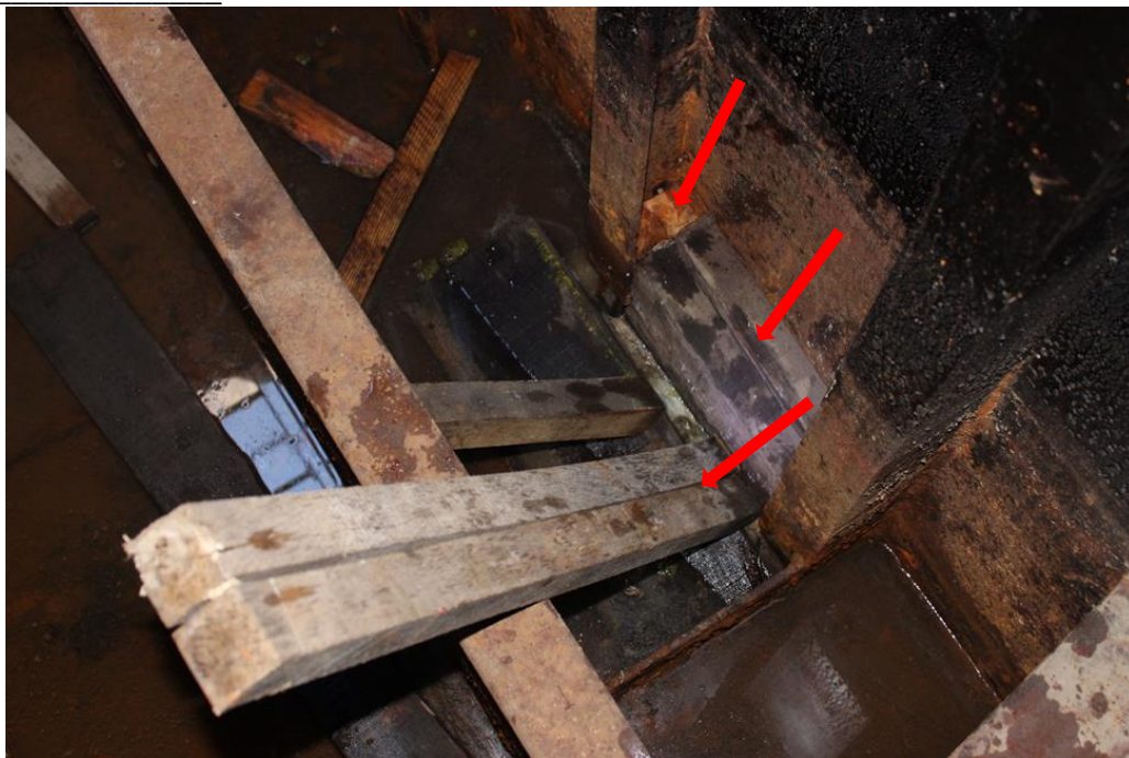
Слика 4.1.1.12. Масни бал на месту пробоја потиснице „SL 23001“
