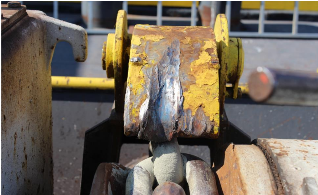
Слика 4.1.1.10. Оштећење западача (осигурач) сидреног ланца
