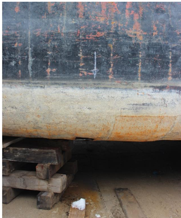
Слика 4.3.1.12. Обележена зона истрошености оплате и продора ради узимања узорка
