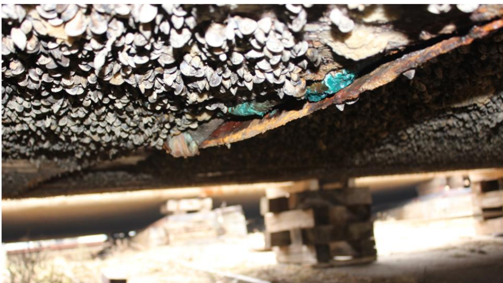
Слика 4.3.1.14. Отворена пукотина оплате дна у зони уздужнице брода, на дну трупа у правцу лома
