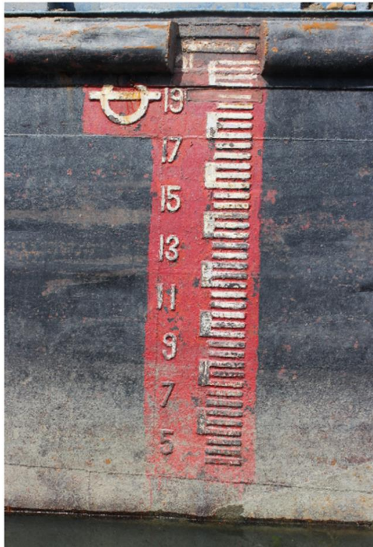
Слика 4.3.1.4. Баждарска плочица у зони просеченог челичног одбојника
