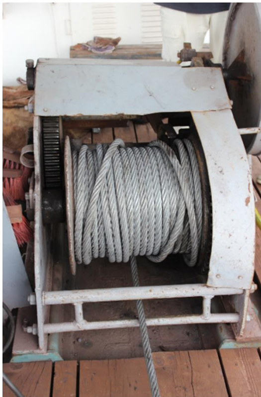
Слика 4.4.1.5. Прамчано електрично притезно витло на броду м/т „GAGRA“
