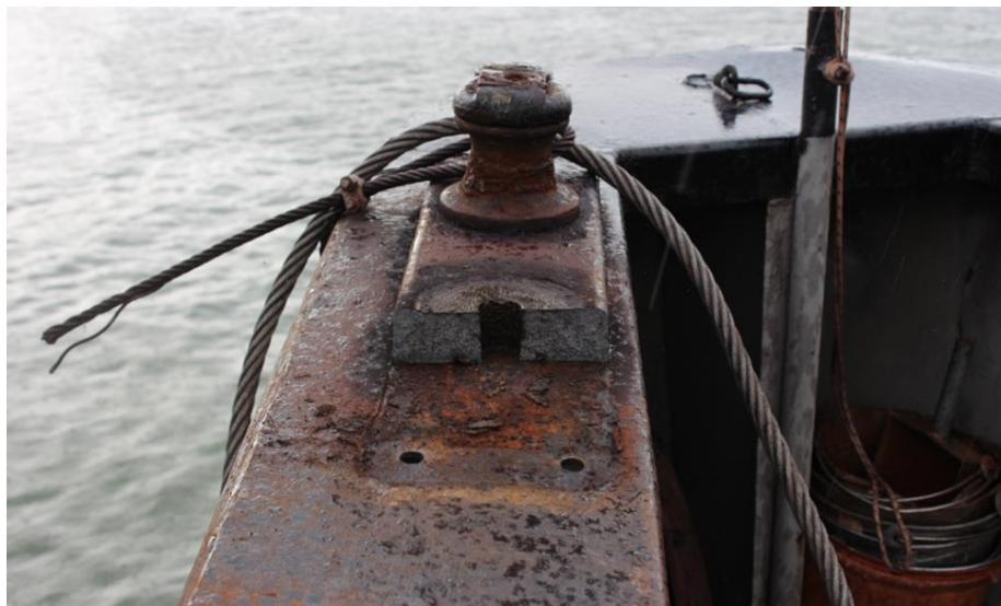
Слика 4.4.1.6. Оштећени део зеваче са покретним ваљком и челичним ужетом Ø 22 mm на левом прамчаном боку таласњаче брода м/т „GAGRA“
