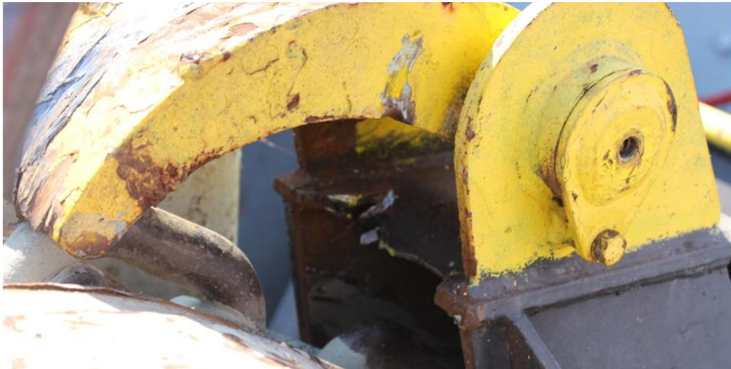
Слика 4.1.1.11. Деформација и оштећење виљушке западача ланца
