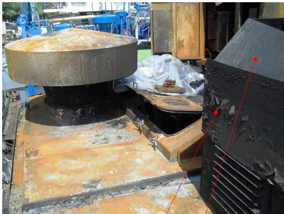
Слика 5.5. На палуби је постављен главни ДЕА, а поред решетке са отворима изнад машинског простора (светларник са отворивим капцима)
