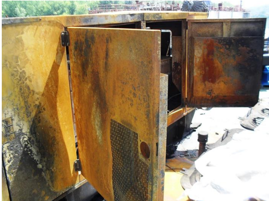
Слика 5.8. Трагови горења на главном ДЕА на палуби нарочито изражени на површинама окренутим ка отвору из машинског простора
