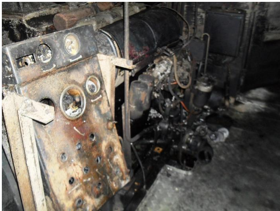
Слика 5.13. Лучки ДЕА који у тренутку пловидбе није био у функцији са траговима контаминације и оштећења као последица присуства топлих продуката сагоревања, а изражено на површинама у горњем делу
