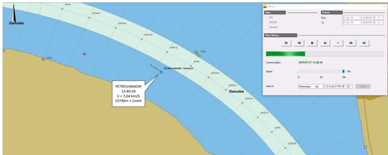
Слика 4.2. Пловидба потискиваног састава при узводној експлоатационој брзини v=7,04 km/h
