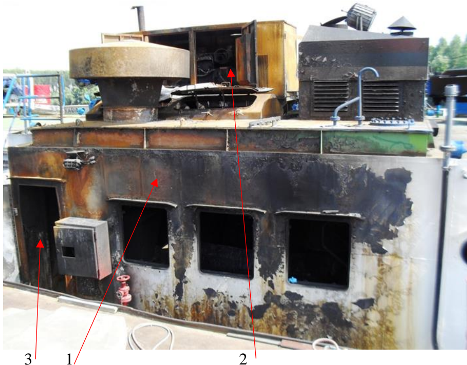
Слика 5.3. Трагови горења изражени у средишњем делу брода-машински простор
