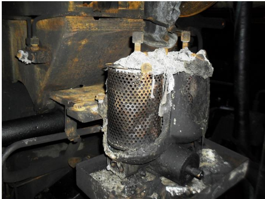
Слика 5.18. Трагови оштећења кућишта филтера (део кућишта истопљен)
