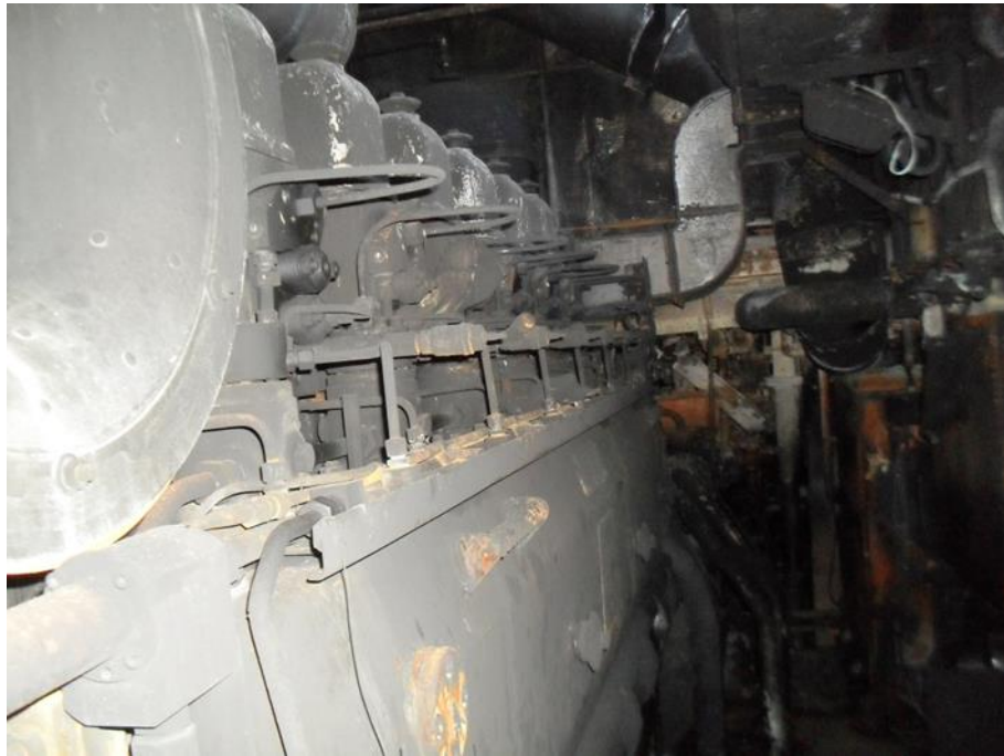
Слика 5.12. На главном левом мотору нема трагова горења, контаминиран и оштећен топлим продуктима сагоревања изражени у горњим површинама
