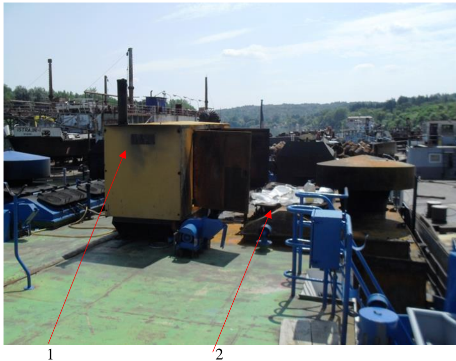
Слика 5.4. На палуби је постављен главни ДЕА, а поред решетке са отворима изнад машинског простора (светларник са отворивим капцима)
