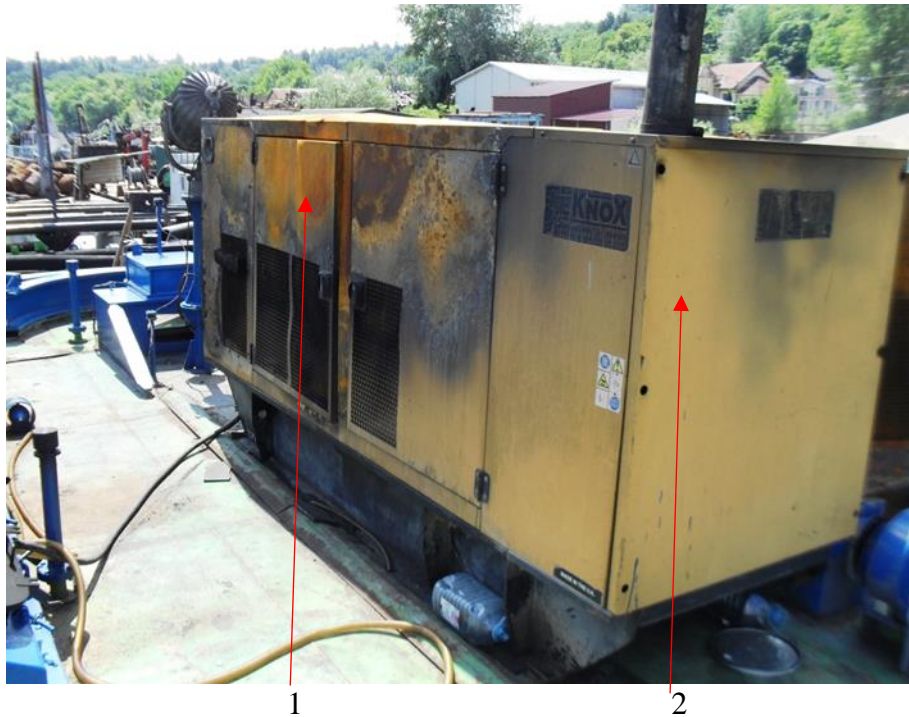
Слика 5.7. Трагови горења на главном ДЕА на палуби изражени на површинама окренутим ка отвору из машинског простора док су са супротне стране изражени на горњим површинама
