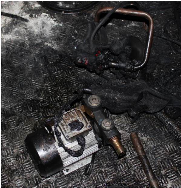
Слика 5.2.2. Оштећена зупчаста преносна пумпа
