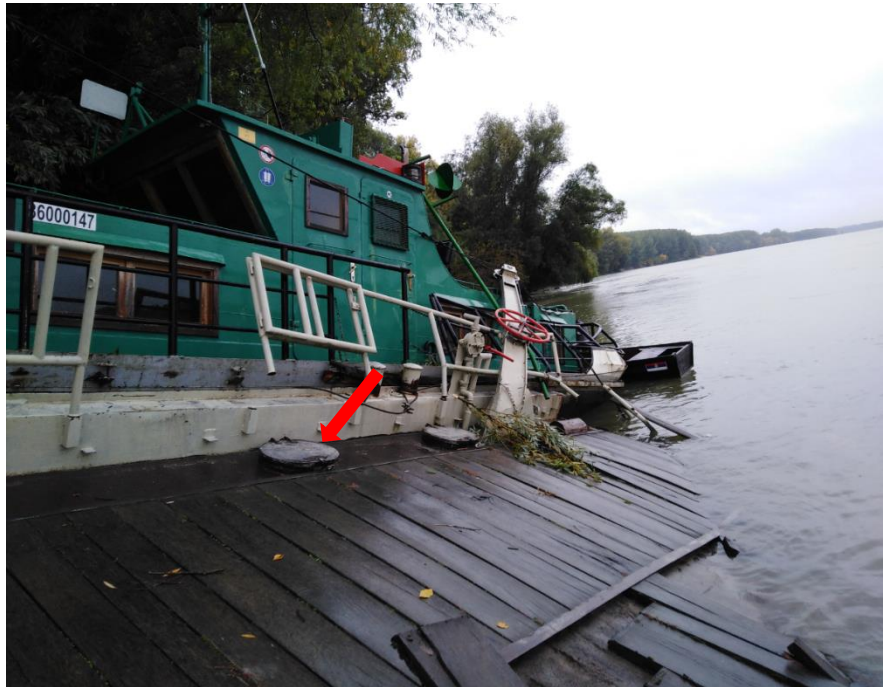
Слика 2.1.3. Црвеном стрелицом означен ревизиони отвор
