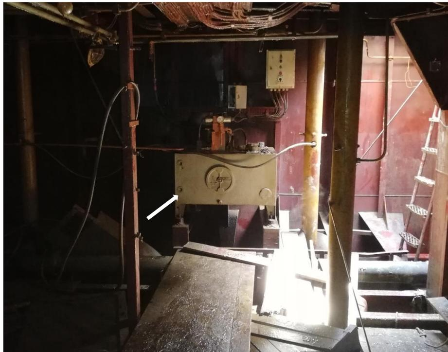
Слика 5.27. Танк хидраулике са електромотором
