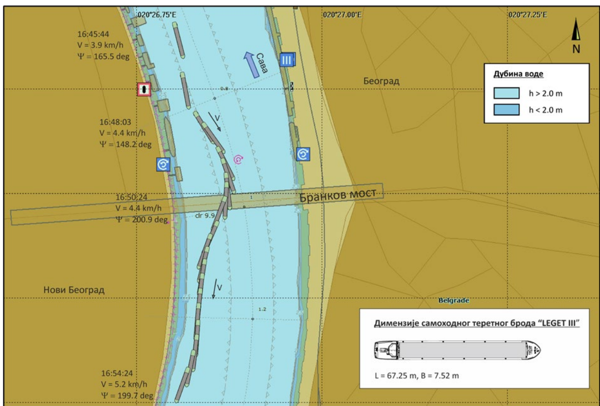
Слика 5.2.1.1. Трајекторија моторног теретног брода „LEGET III“ при узводној пловидби испод Бранковог моста
