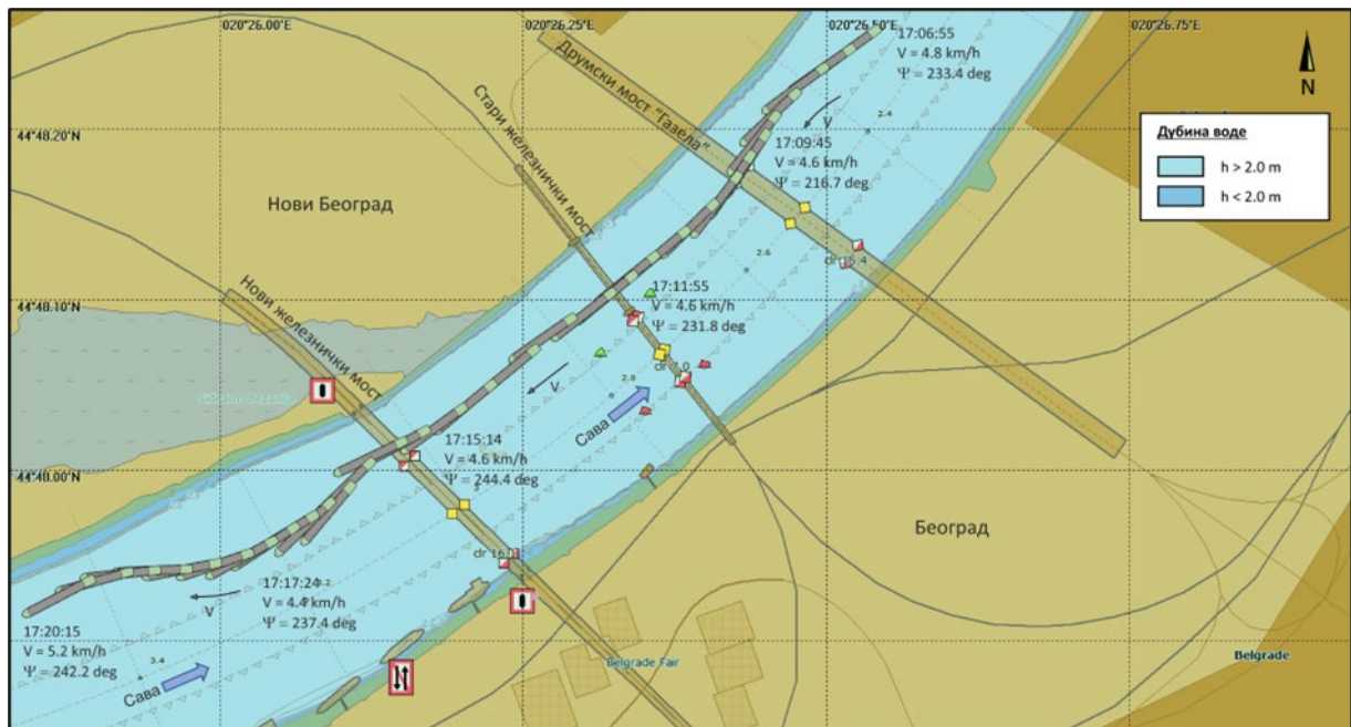
Слика 5.2.3.1. Трајекторија моторног теретног брода „LEGET III“ при узводној пловидби испод друмског моста „Газела“ и железничких мостова
