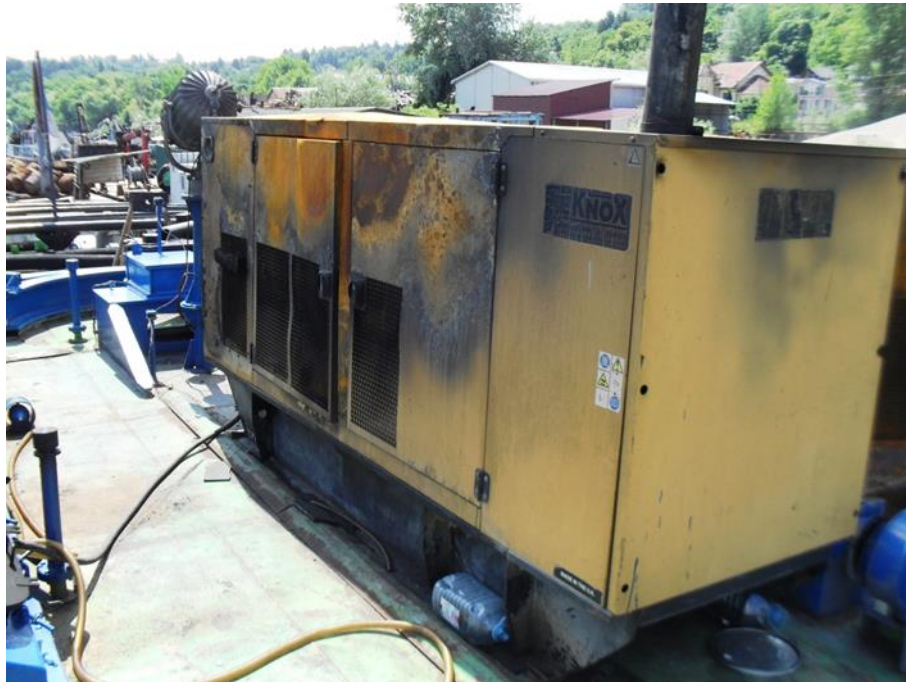
Слика 4.1.1.6. Трагови горења на главном ДЕА на палуби изражени на површинама окренутим ка отвору из машинског простора док су са супротне стране изражени на горњим површинама
