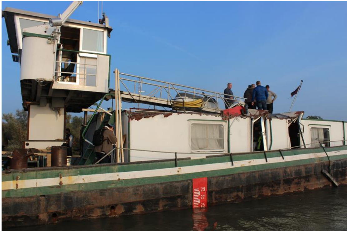
Слика 3.6.3. На броду с/т „NINA“ оштећена надградња стамбеног простора, оштећени улази у стамбене просторије у виду пластичних деформација улазних врата и околне конструкције истих, пластична деформација двоструке стубасте битве, позиција задња, крена средња
