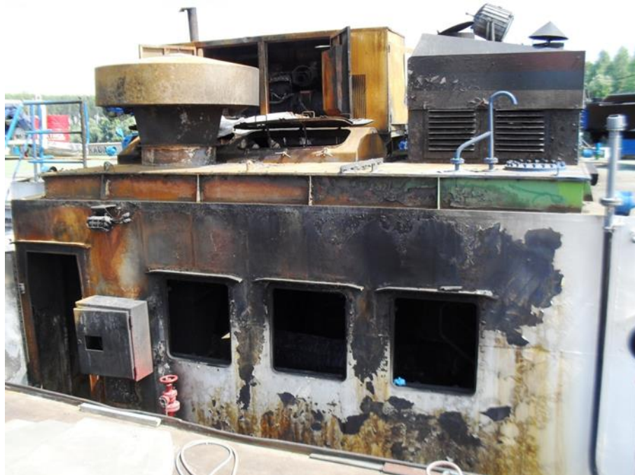
Слика 4.1.1.3. Трагови горења изражени у средишњем делу брода п/л „PETROVARADIN“
