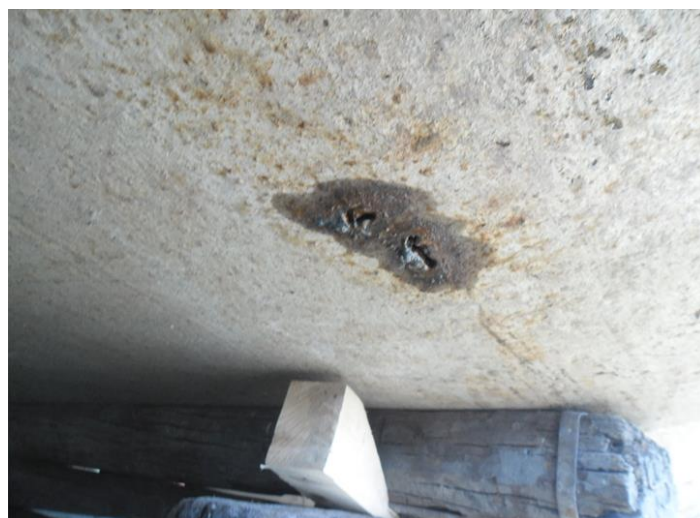
Слика 4.4.1.3. Пробој оплате трупа брода с/г „ТИТЕЛ“
