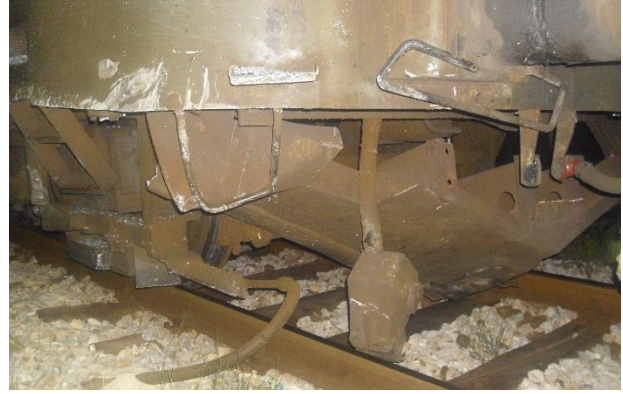
Слика 3.4.4.2: Изглед оштећења на лок.441-707
