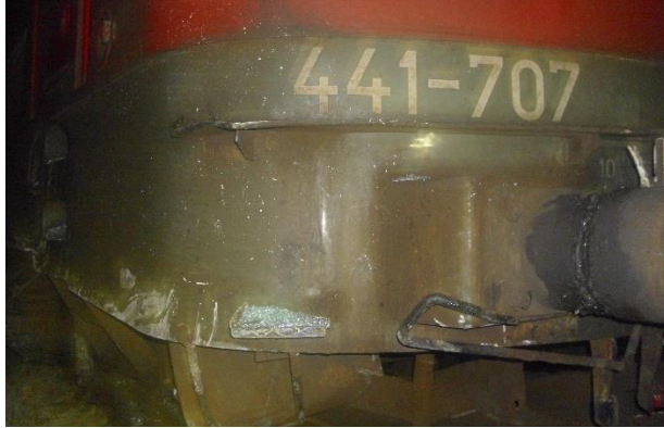
Слика 3.4.4.1: Изглед оштећења на лок.441-707
