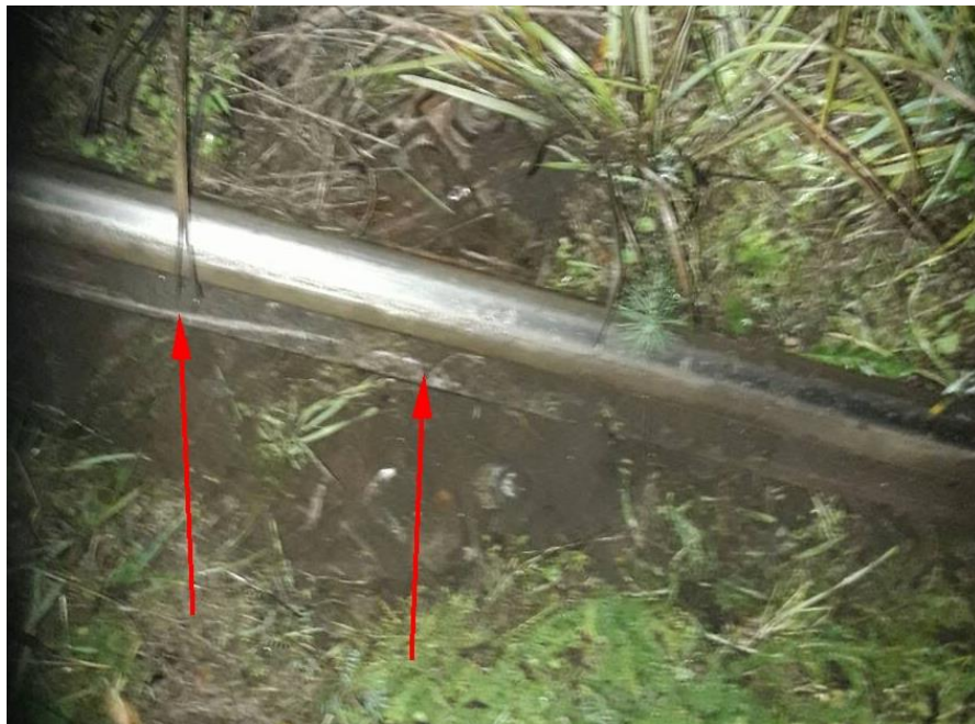
Слика 4.1.3: Траг испдања точка на спољашњу страну десне шине (извор: „ИЖС“ а.д.)
