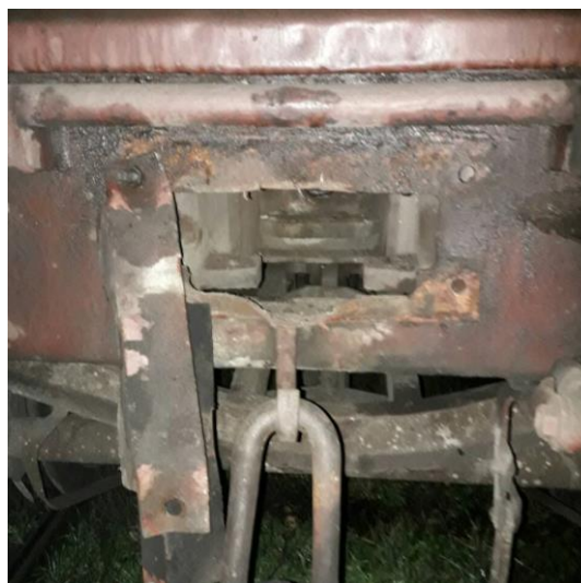
Слика 3.4.4.3: Изглед покиданог влачног уређаја на шестим колима
