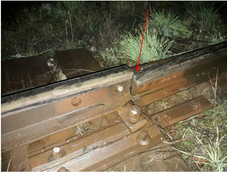
Слика 4.1.2: Траг удара и пењања точка на помереном саставу леве шине и пукнута везица (извор: „ИЖС“ а.д.)
