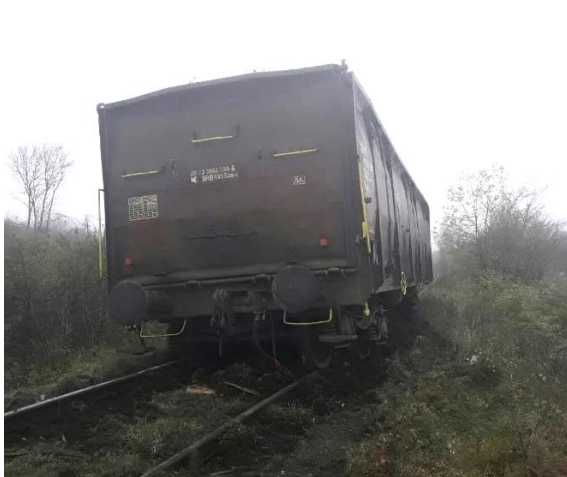
Слика 3.4.4.1: Изглед исклизлих кола
