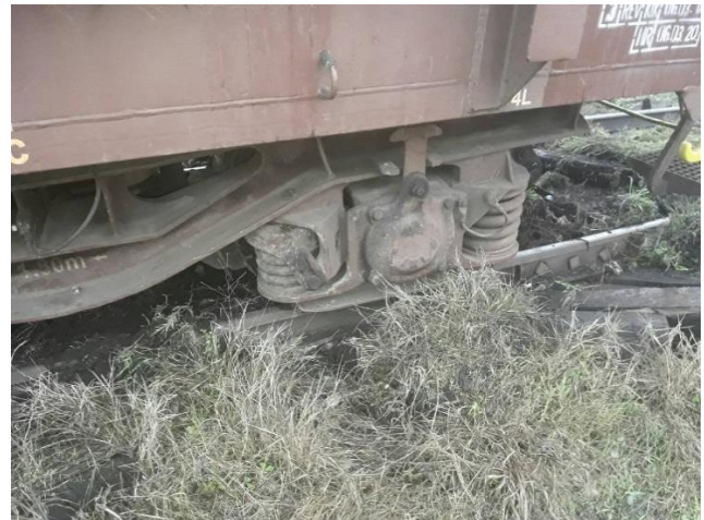
Слика 3.4.4.2: Изглед исклизлих кола
