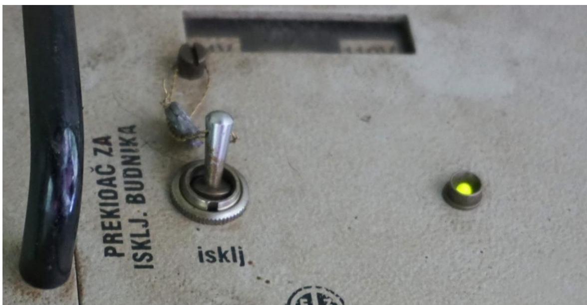
Слика 3.4.4.1: Изглед прекидача електронског дела будника на локомотиви 661-162
