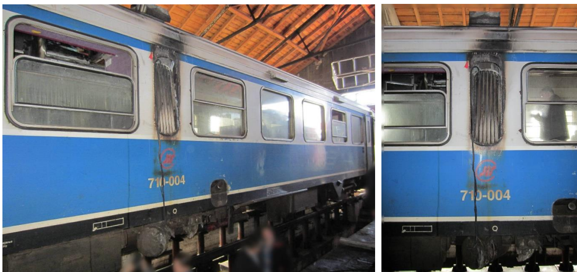
Слика 4.1.1.1: Изглед ДМК 710-004 захваћен пожаром (средишњи део споља)
