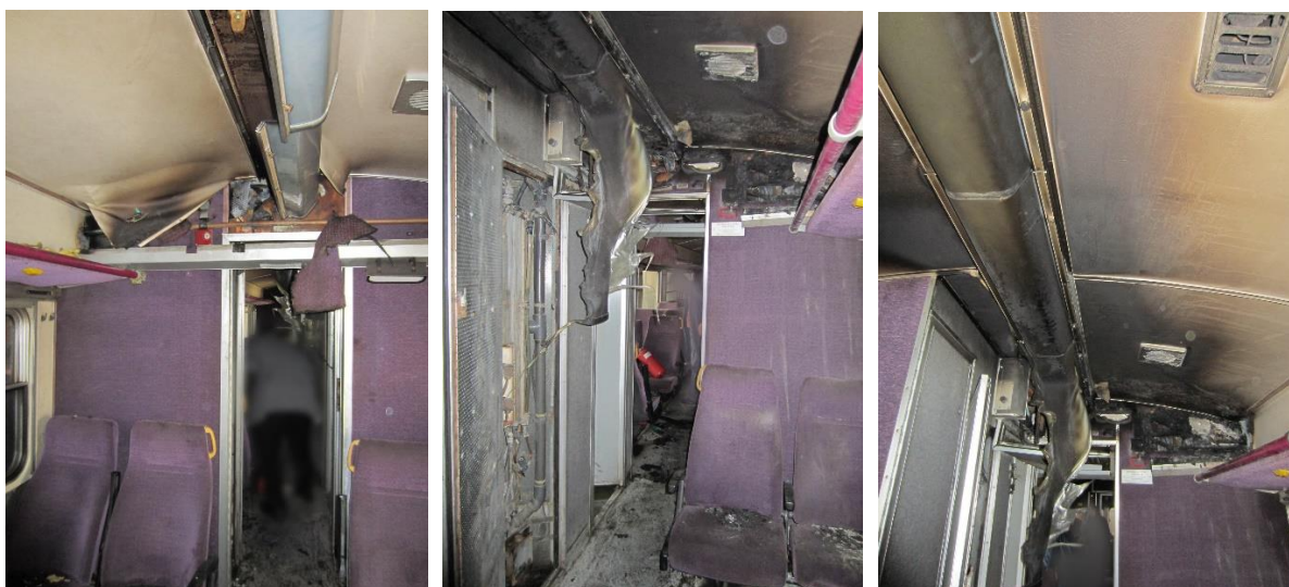
Слика 4.1.1.2: Изглед простора за путнике ДМК 710-004 захваћен пожаром
