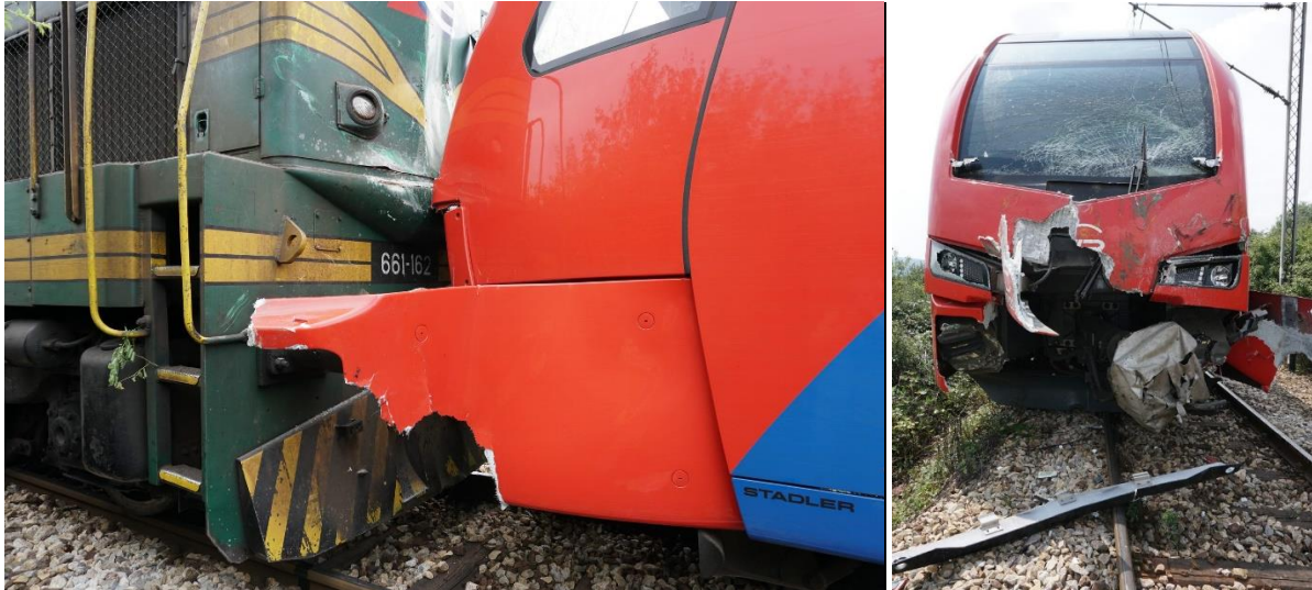
Слика 4.3.1.1: Изглед оштећења на железничким возилима након судара возова
