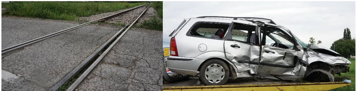
Слика 2.1.2.1: Изглед трагова на коловозу на путном прелазу и оштећења на друмском путничком возилу
