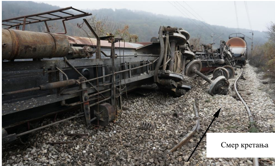
Слика 4.2.1.5: Деформисани леви колосек
