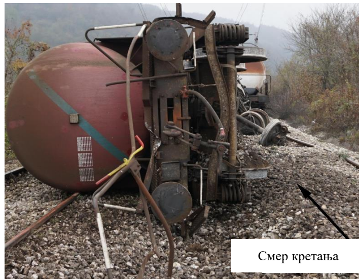
Слика 4.2.1.6: Неоштећени вучни уређаји на крају осмих кола
