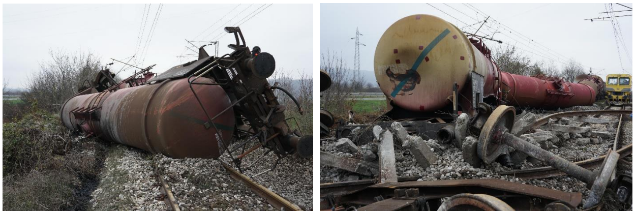
Слика 3.4.4.2: Изглед исклизлих и преврнутих кола
