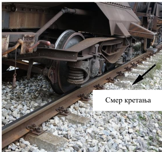
б) Задње исклизло обртно постоље 13-тих кола
