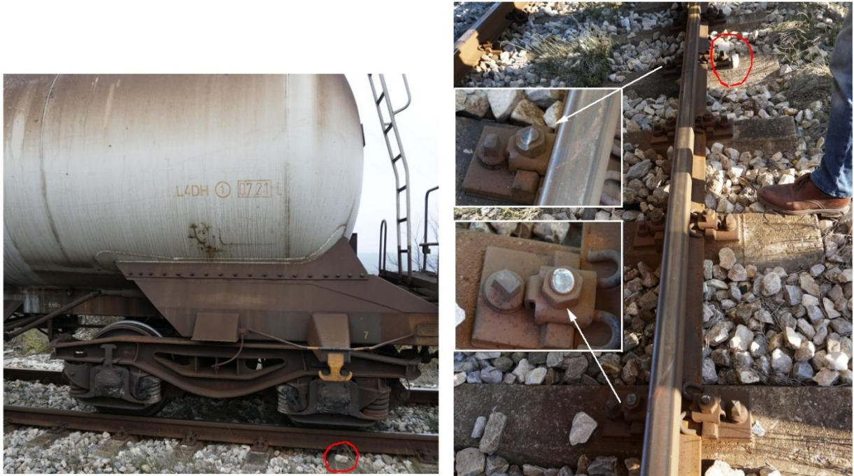
Слика 4.2.5.5: Први траг исклизнућа од тринаестих исклизлих кола
