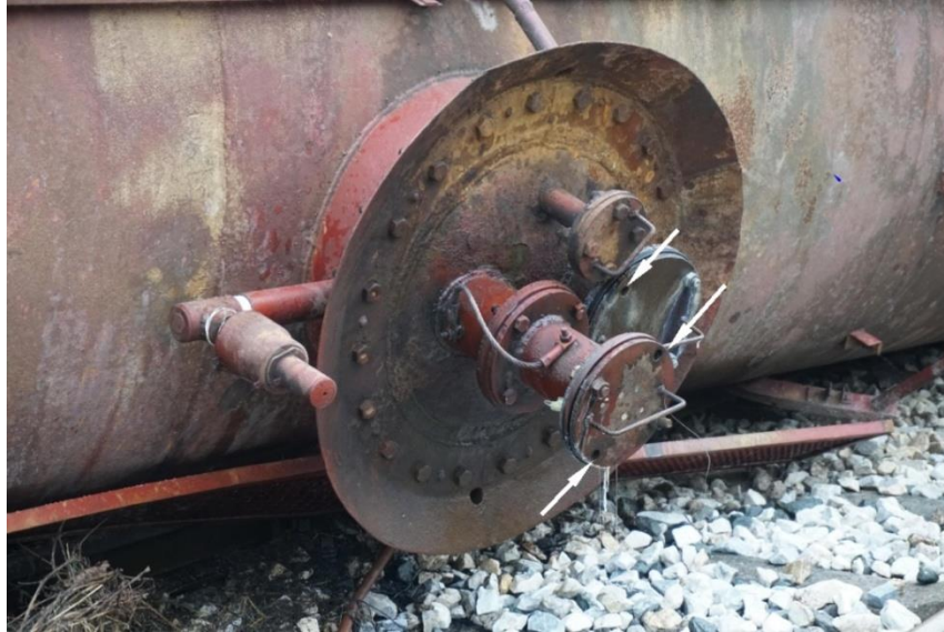
Слика 4.2.1.3: Цурење сумпорне киселине из кола број 31 72 7865 013-8
