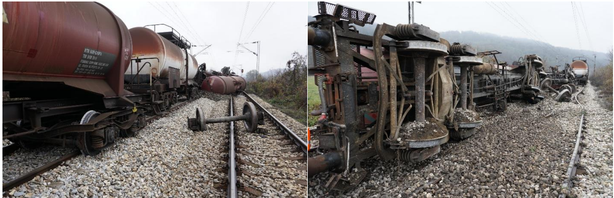
Слика 3.4.4.1: Изглед исклизлих и преврнутих кола
