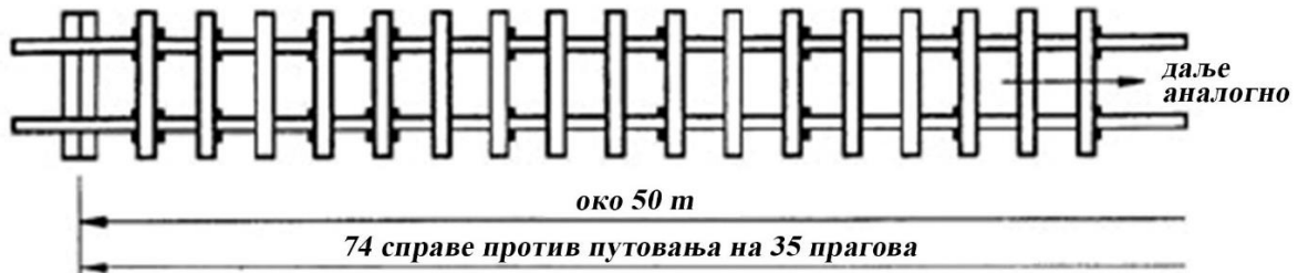
Слика 3.4.2.5: Начин уградње справа против путовања шина
