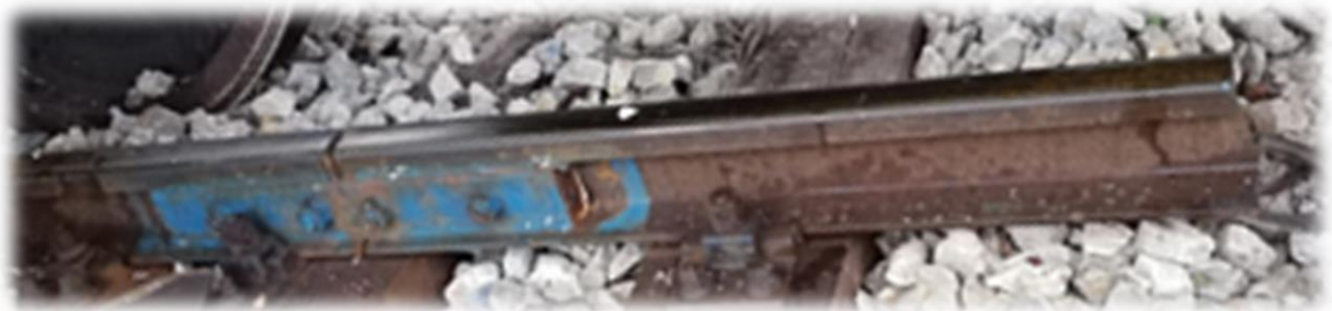
Слика 4.2.10.3: Изглед прснућа десне шине у смеру растуће стационаже левог колосека у km 123+660,20
