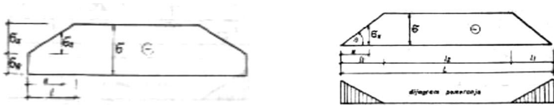
Слика 4.2.9.2: Дијаграм напона и померања у шини у зависности од температуре
