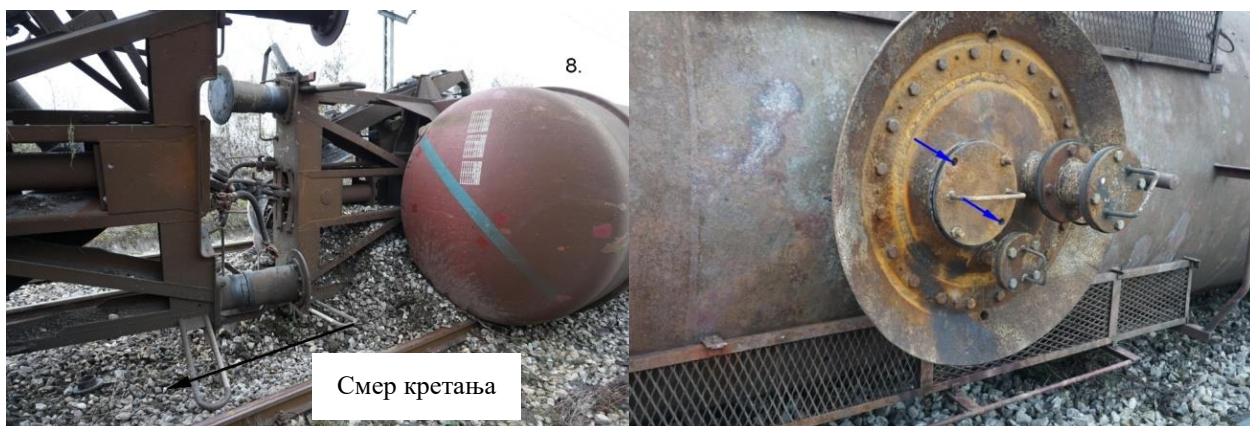
Слика 4.2.1.4: Преврнута осма кола број 33 72 7867 853-3 и цурење сумпорне киселине на поклопцу
