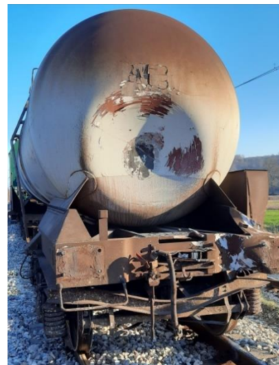
в) Оштећење 13-тих кола (снимљено по уклањању 12-тих кола)
