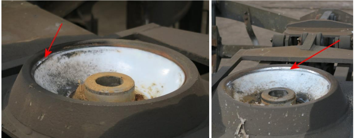
Слика 4.2.2.1.2: Шоље обртних постоља кола број 33 72 7867 810-3
