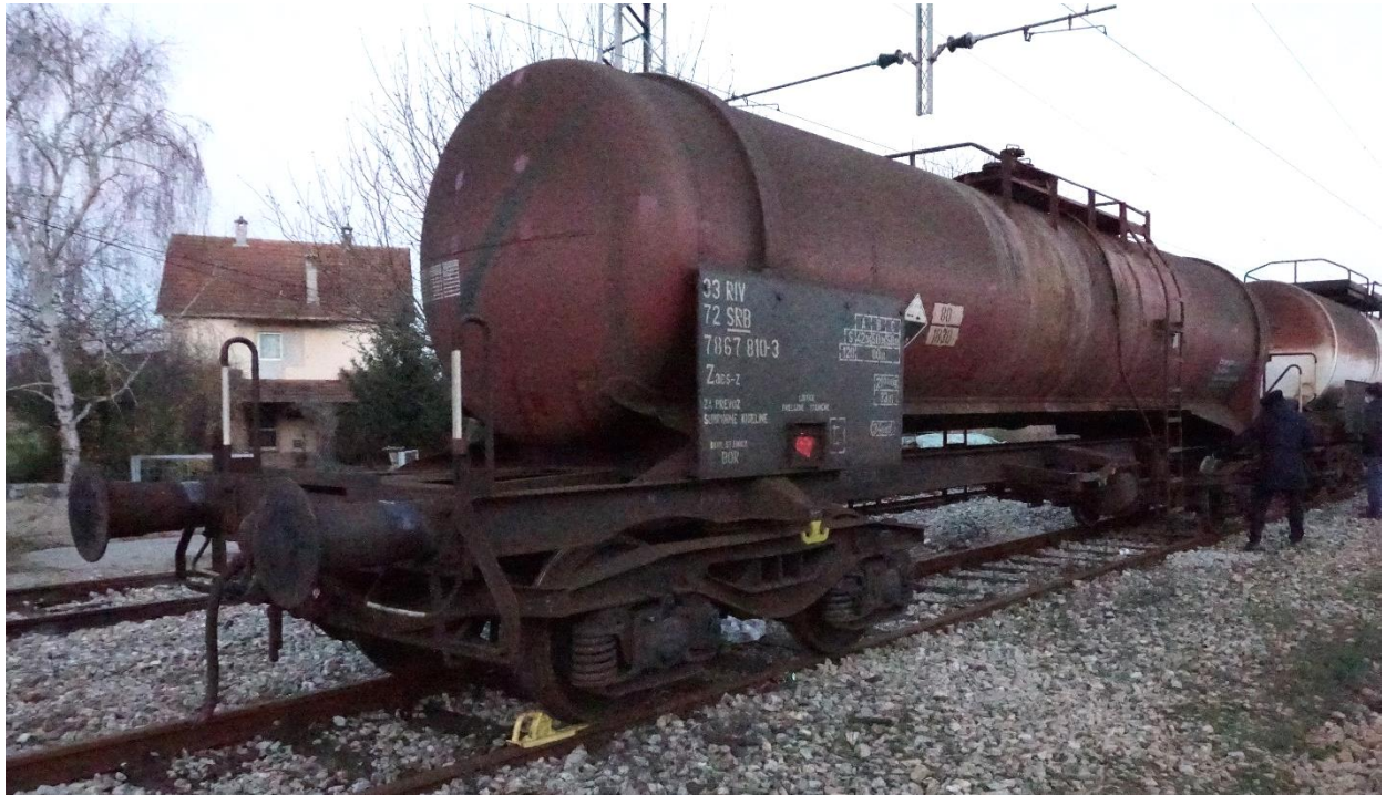
Слика 2.2.2.1: Изглед кола серије Zacs која су исклизла у предметној несрећи
