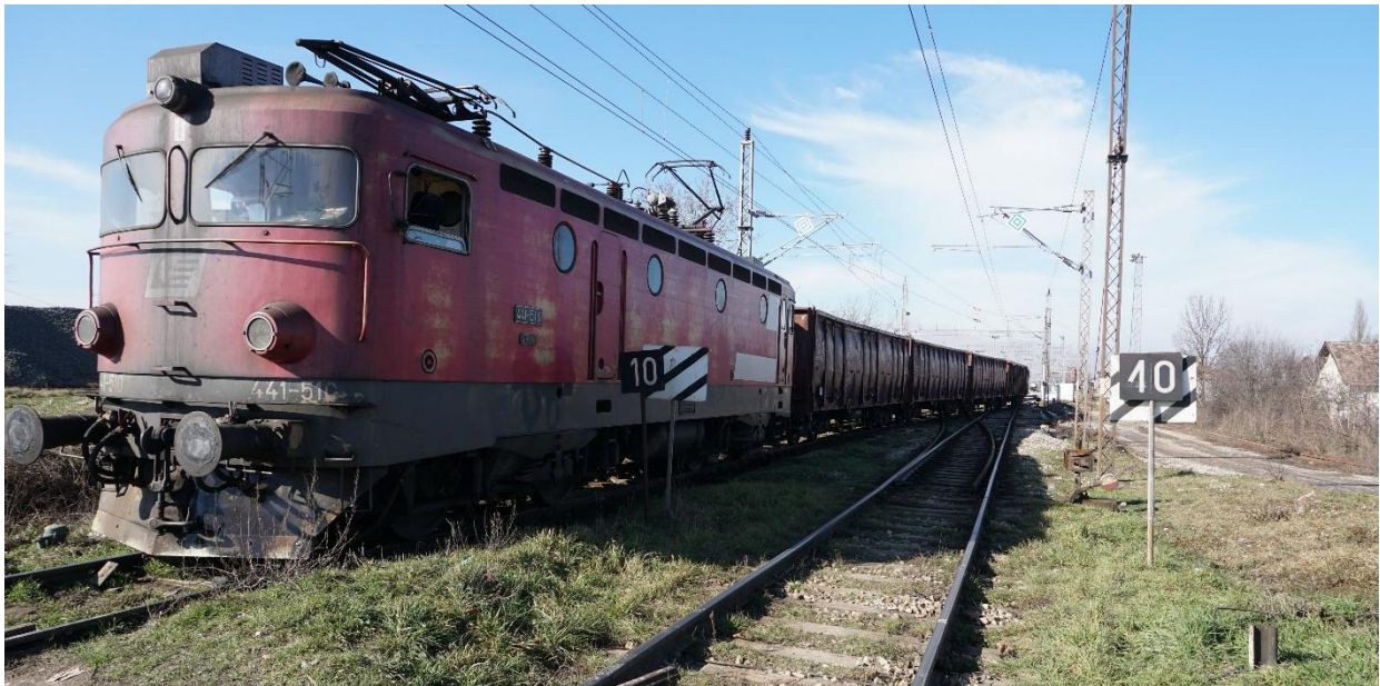
Слика 2.2.2.6: Изглед сигналног знака 97в: „Почетак лагане возње“ на блоку 2 станице Мала Крсна (посматрано од стране станица Осипаоница и Пожаревац ка станици Мала Крсна)
