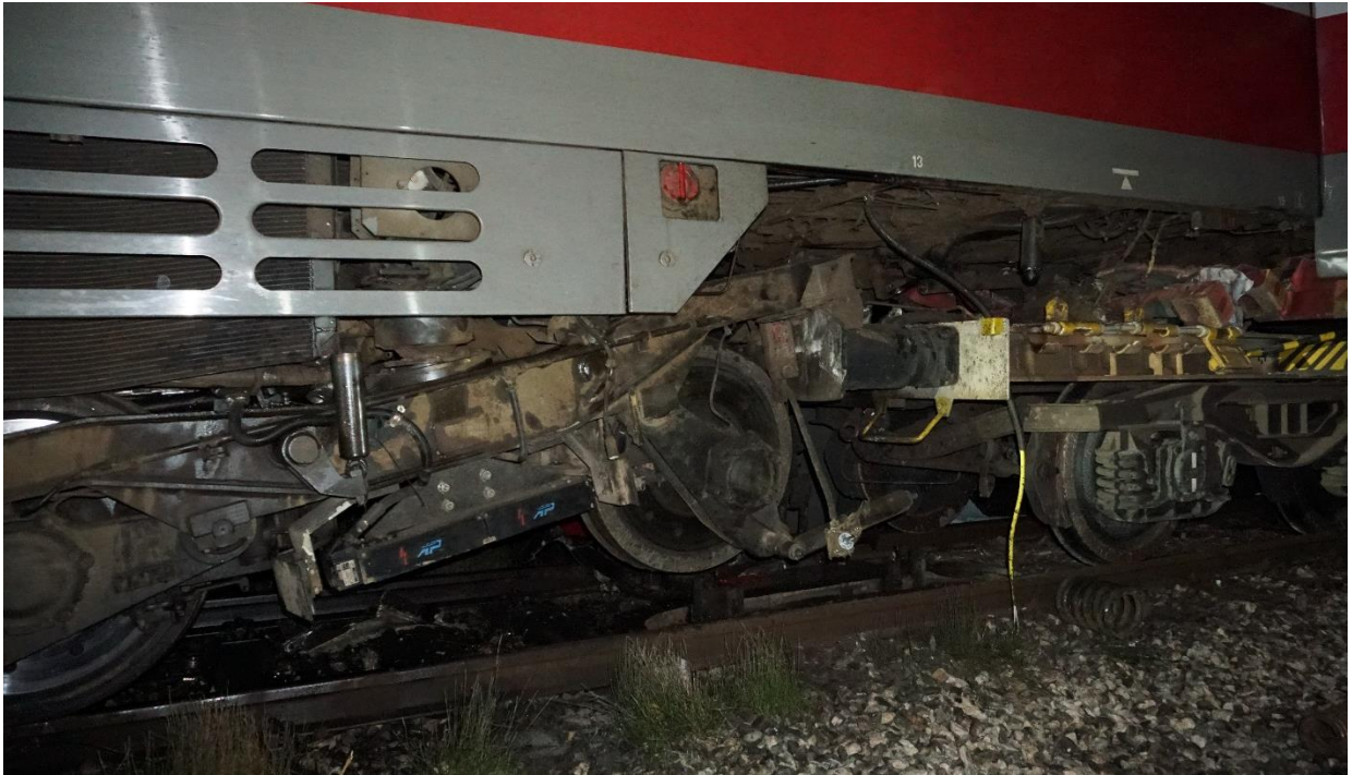
Слика 4.1.4: Изглед помереног обртног постоља на ДМВ 711-078
