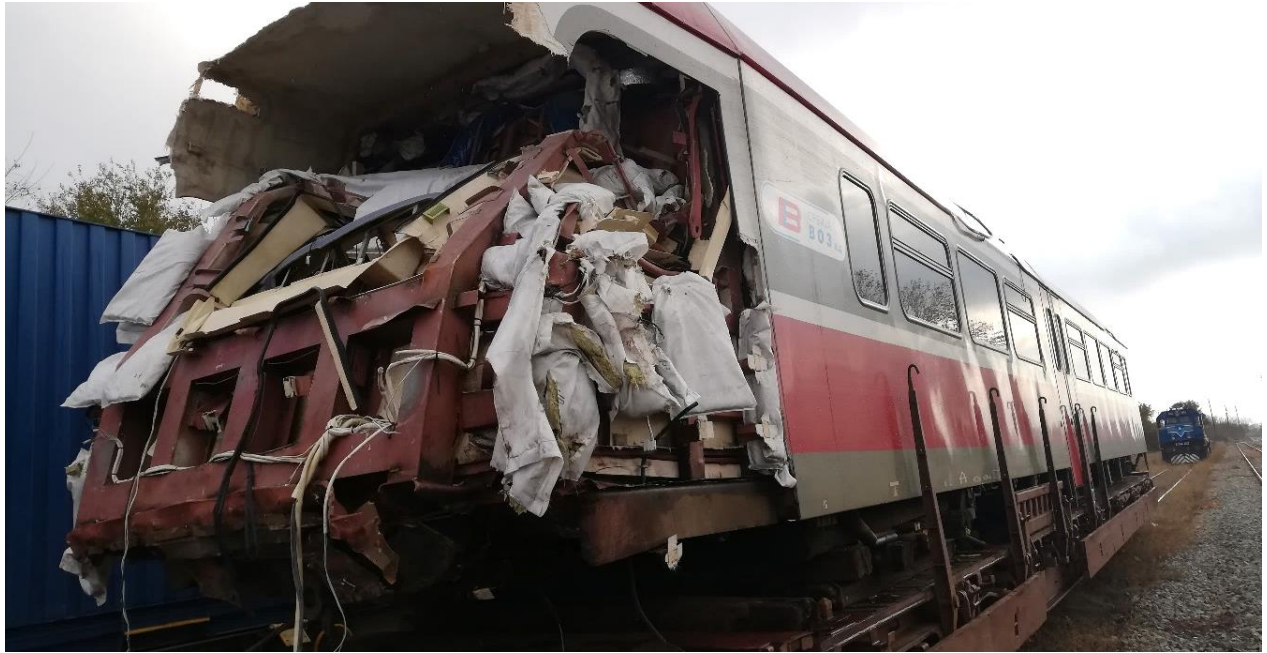
Слика 3.4.4.2: Спољашњи изглед управљачнице моторних кола 711-078 ДМВ 711-077/078 код воза број 25412 после озбиљне несреће
