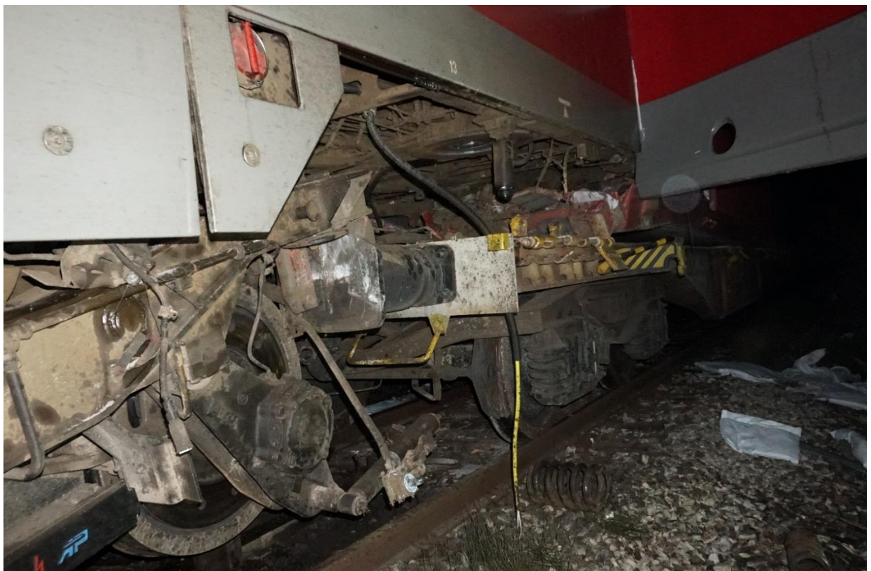
Слика 4.1.3: Изглед оштећења на колима број 33 68 4952 037-2
