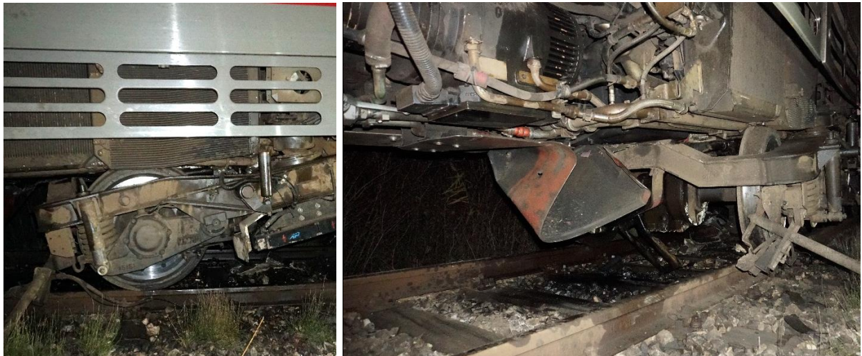
Слика 4.1.5: Изглед оштећења на погонској групи ДМВ 711-078
