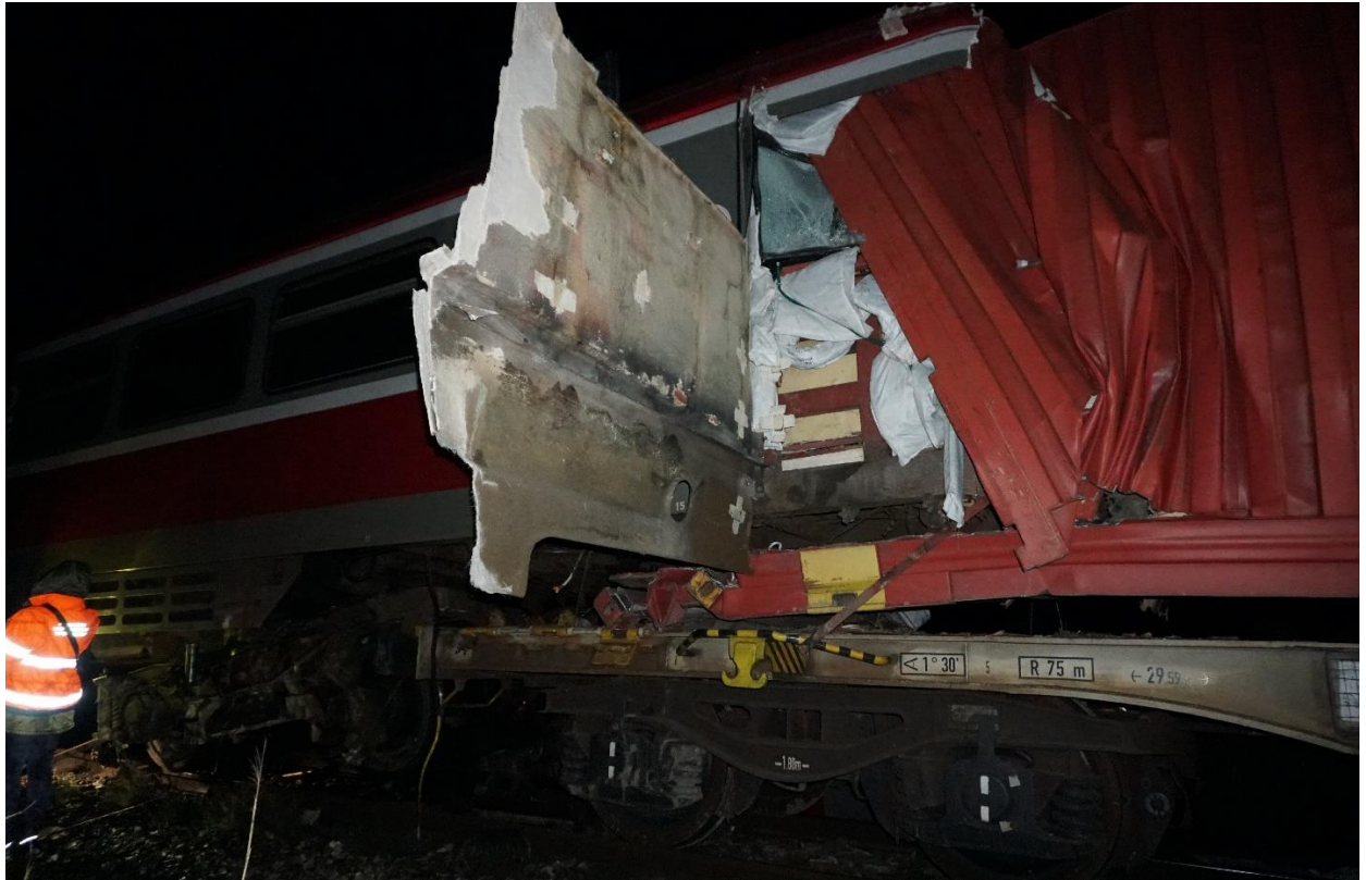
Слика 4.1.2: Изглед оштећења на предњем делу сандука ДМВ 711-078 и контејнеру број CNEU 453486-3
