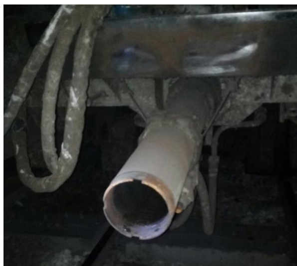
Слика 3.1.2: Изглед дела раскинутог квачила на моторним колима 412-061
