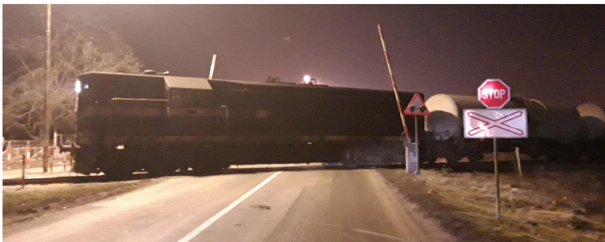
Слика 4.2.1.1: Изглед маневарске локомотиве 661-155 након озбиљне несреће (поглед у смеру кретања друмског путничког возила, извор: „НИС“ а.д.)
