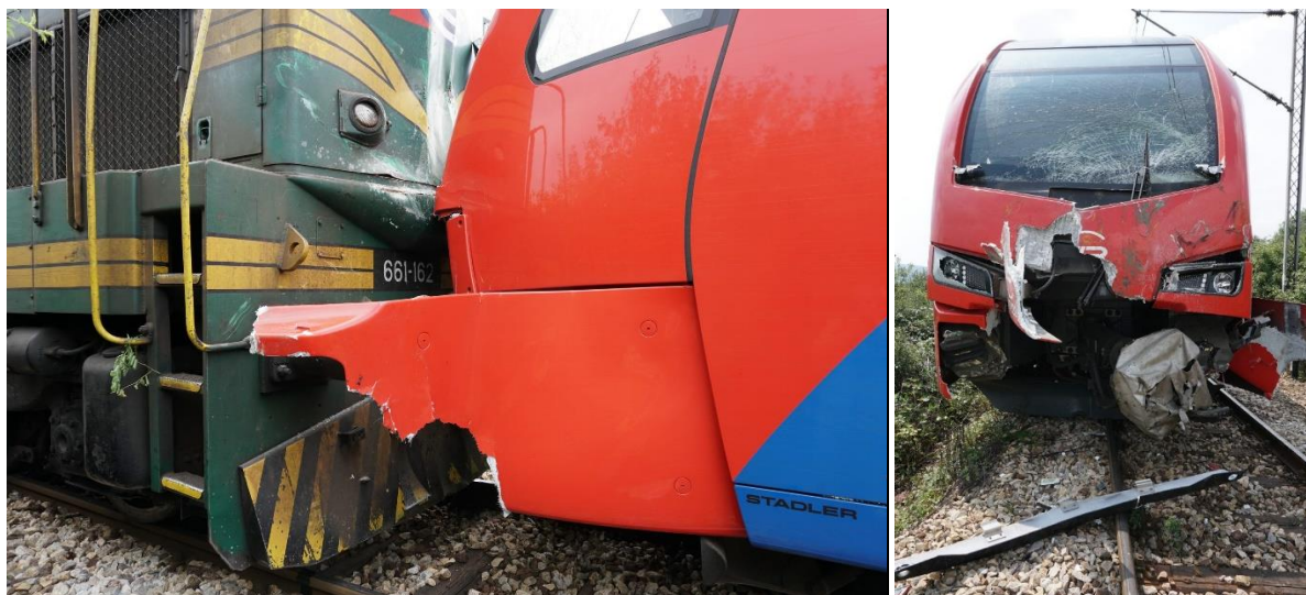
Слика 3.3.1: Изглед оштећења на железничким возилима након судара возова
