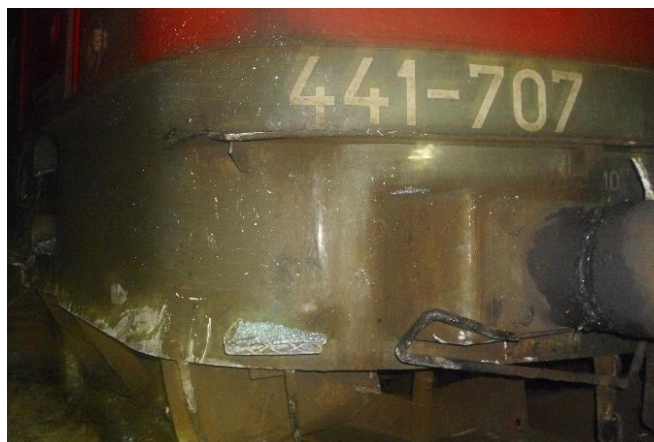
Слика 4.2.1.2: Изглед оштећења на лок.441-707
