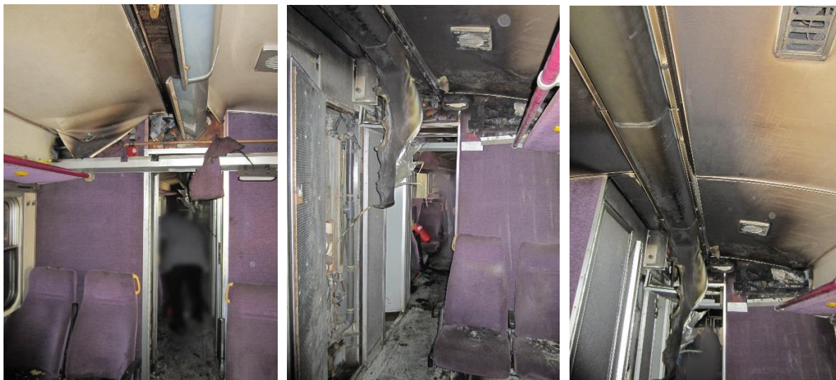
Слика 3.1.2: Изглед простора за путнике ДМК 710-004 захваћен пожаром
