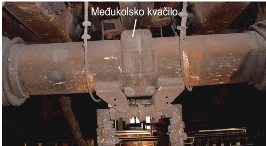
Слика 4.1.1.1: Изглед међуколског квачила уграђеног на ЕМВ серије 412/416
