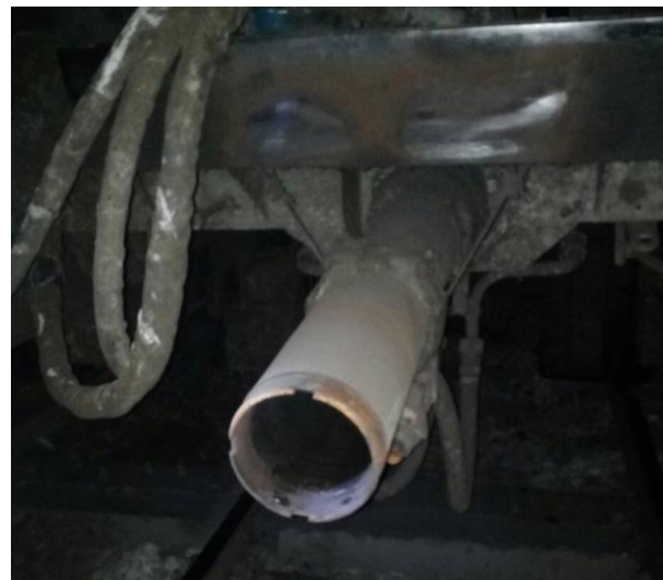
Слика 4.1.1.3: Изглед дела раскинутог квачила на моторним колима 412-061
