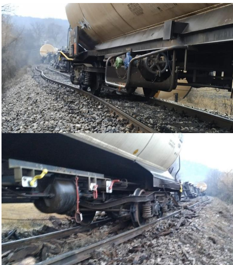
Слика 3.1.4: Изглед исклизлих деветих (горе) и четрнаестих кола (доле) (извор: „ИЖС“ а.д.)
