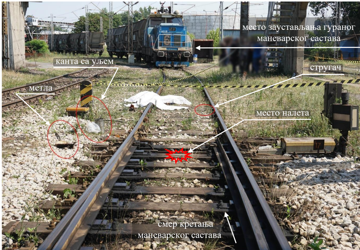
Слика 4.2.1.1: Изглед места озбиљне несреће после налета гураног маневарског састава на пружног радника (поглед из смера другог колосека ка другом извлачњаку)
